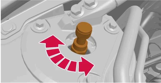
Para modificar la posición de ajuste, gire el botón de ajuste bien en el sentido de las agujas del reloj o en sentido contrario al de las agujas del reloj.
