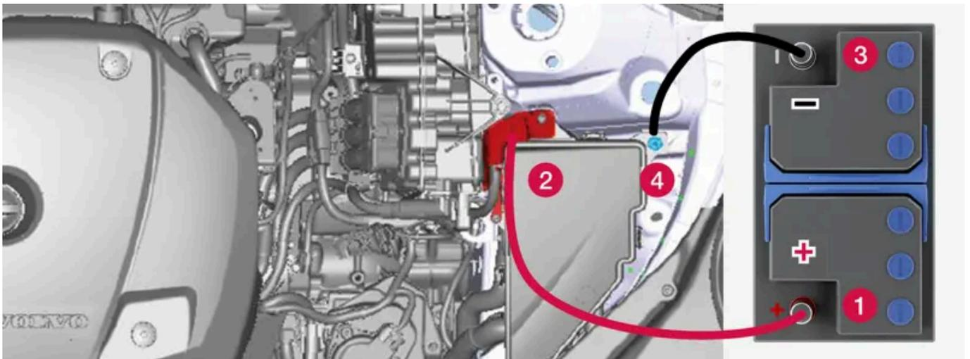
Puntos de carga para asistencia de arranque desde el vehículo propio. El aspecto del compartimento del motor puede variar en función del modelo de automóvil y del nivel de equipamiento.
