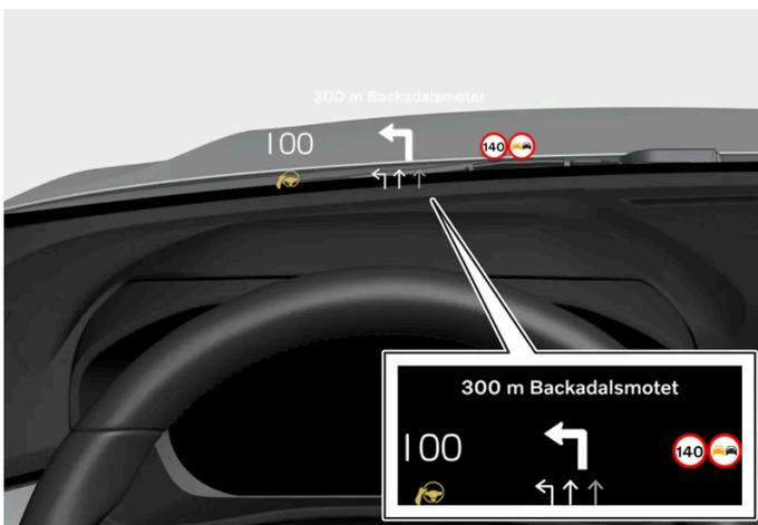
La pantalla de visualización frontal muestra información seleccionada que el conductor debe gestionar tan pronto como sea posible. Puede tratarse, por ejemplo, de advertencias de tráfico, información sobre la velocidad y navegación. En la pantalla de visualización frontal se muestra también información sobre señales de tráfico y llamadas telefónicas. Esta pantalla se controla con el teclado derecho del volante y desde la pantalla central.
