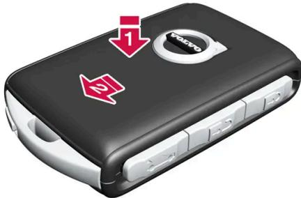
Recoloque la carcasa delantera en el orden inverso a su desmontaje. Encaje la carcasa con un chasquido y, a continuación, deslice los últimos milímetros a su posición original.
