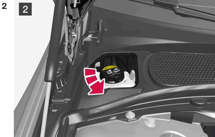
Desenrosque el tapón del depósito de expansión y añada refrigerante si es necesario. El nivel de refrigerante debe estar entre las cotas de MIN y MAX en el depósito de expansión.
