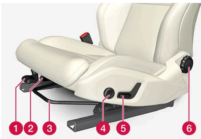
1 Para ajustar en altura el borde delantero del asiento\*, presione hacia arriba o hacia abajo.<sup>[1]</sup>
