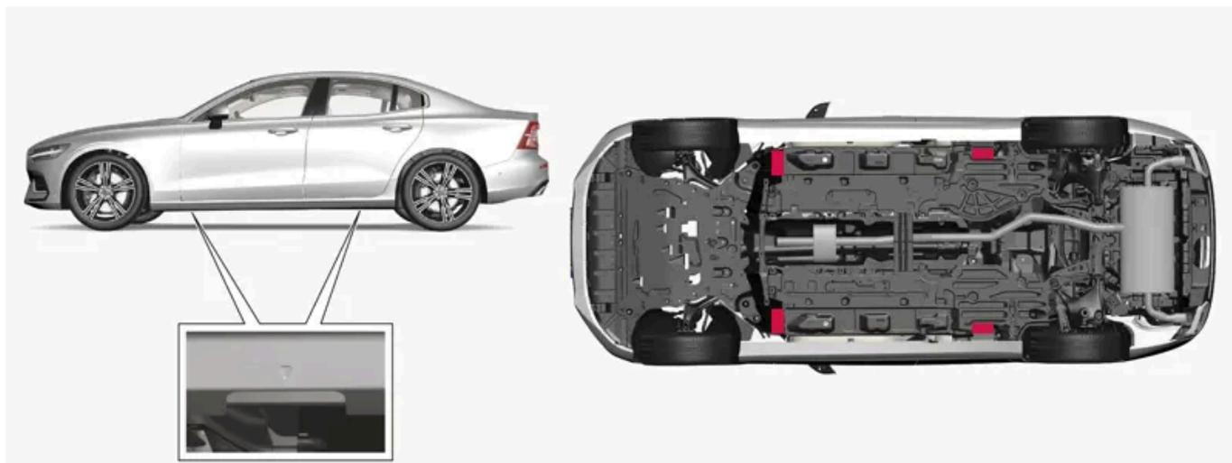
Las flechas del borde inferior del lateral del automóvil indican la ubicación de las fijaciones de gato/puntos de elevación (señalados en rojo).
