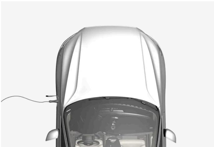
La batería híbrida se carga a través del cable de carga pero también con frenadas suaves y con el freno motor en la posición de cambio B. La batería híbrida puede cargarse también con el motor de combustión del vehículo. La batería de arranque del automóvil se carga al cargar la batería híbrida.
