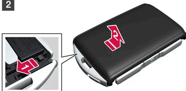
Desplace a un lado el fiador situado detrás de la carcasa delantera y saque la carcasa trasera hacia afuera de la fijación de llavero.
