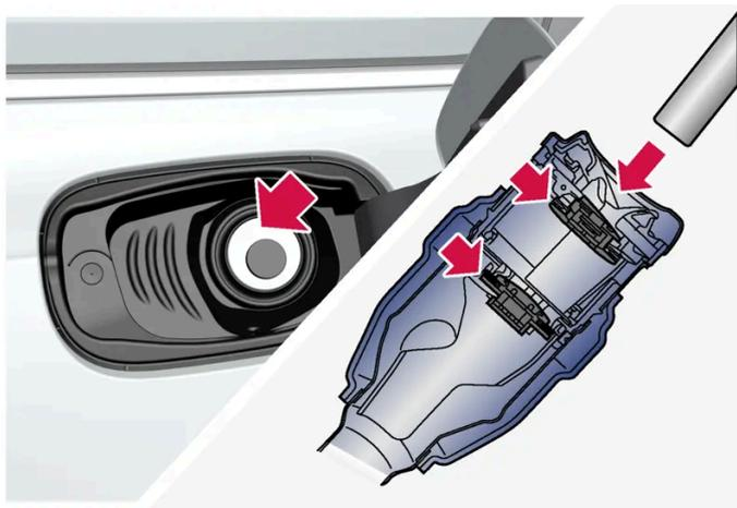
Antes de empezar a repostar, es importante introducir la boquilla del surtidor a través de los dos cierres del tubo de llenado.
