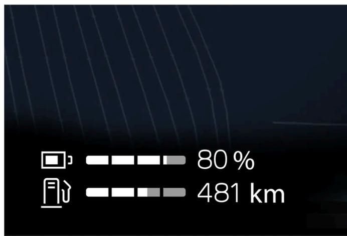
El indicador de batería de la parte inferior de la pantalla del conductor muestra su nivel de carga y el recorrido que puede realizar hasta agotarse la batería.
