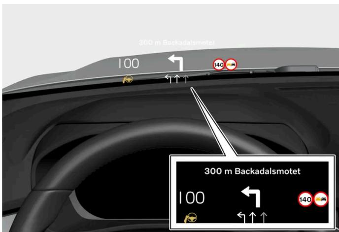
La pantalla de visualización frontal proyecta información de la pantalla del conductor en el parabrisas, frente al conductor. La información solo se puede visualizar desde la posición del conductor.
