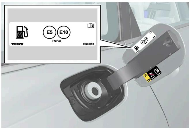
Seleccione el combustible homologado para su uso con el vehículo conforme al identificador<sup>[1]</sup> del interior de la portezuela del depósito. Consulte la información relativa a los combustibles homologados y el identificador en el apartado "Gasolina".
