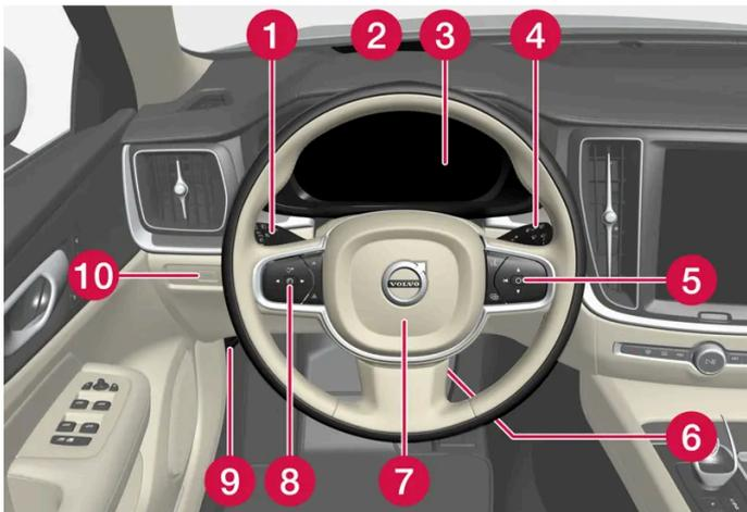
**1** Luces de posición, luces diurnas, luces de cruce, luces largas, intermitentes, luz antiniebla trasera, puesta a cero de cuentakilómetros parciales
