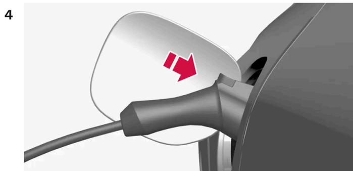
Retire la tapa de protección del mango de carga y encaje este a continuación hasta el fondo de la toma de vehículo.
