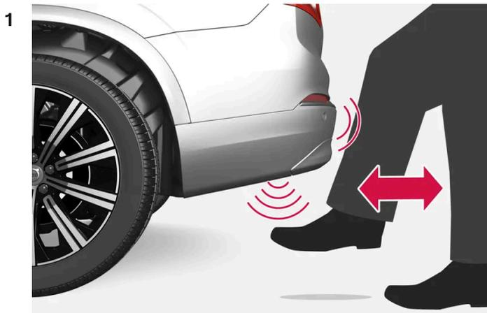
Movimiento con el pie en la zona de activación del sensor.
