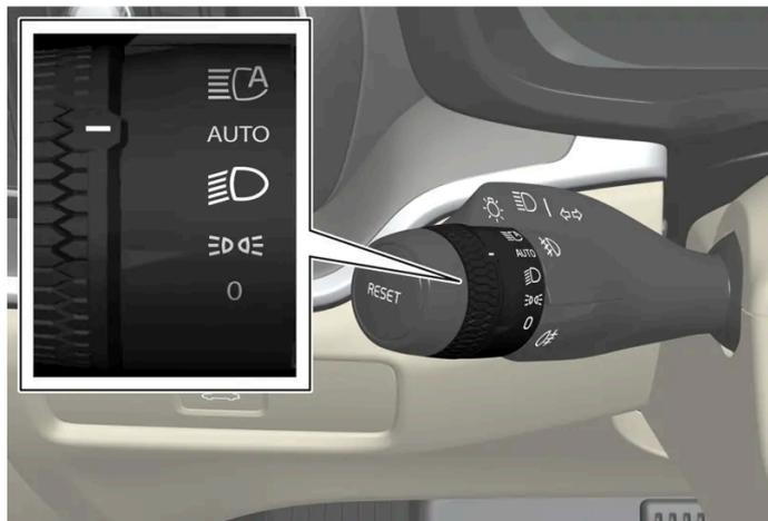
Mando giratorio de palanca izquierda del volante.
