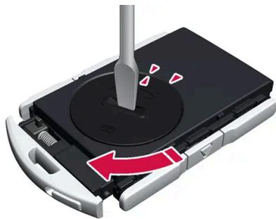
Recoloque la tapa de la pila y gírela a la derecha a la posición CLOSE.
