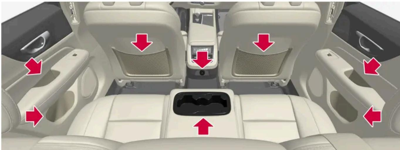
Compartimento en el panel de puerta, portavasos\* en el respaldo de la plaza central, bolsillo\* en el respaldo del asiento delantero y puertos en la consola del túnel.
