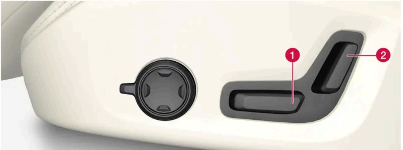
1 Para ajustar el asiento del acompañante en longitud, desplace el control hacia adelante y hacia atrás.
