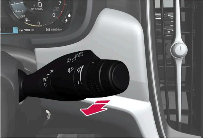
Función de lavado, palanca derecha del volante.
