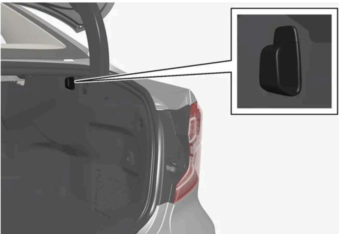
Hay un gancho para bolsas de la compra en los paneles de ambos lados del compartimento de carga.
