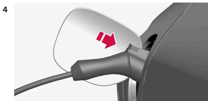
Retire la tapa de protección del mango de carga y encaje este a continuación hasta el fondo de la toma de vehículo.
