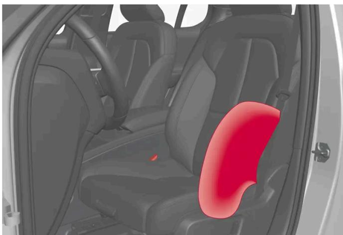
Los airbags laterales exteriores van montados en las estructuras exteriores de los asientos delanteros y ofrecen protección al conductor y el acompañante.
