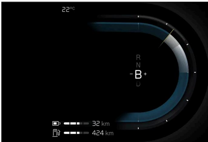
Vista general de la posición de freno en la pantalla del conductor.
