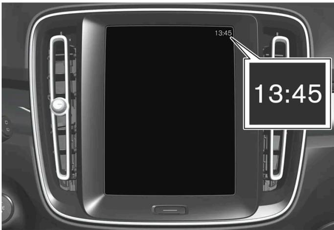
El reloj está situado en la parte superior derecha de la barra de estado de la pantalla central.
