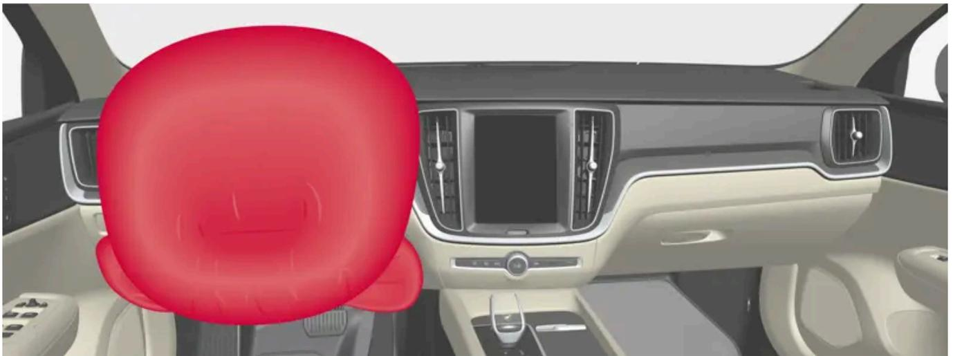
Airbag del volante y airbag de rodillas<sup>[1]</sup> en el lado del conductor del asiento delantero.
