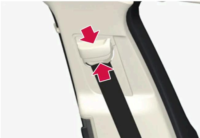
Comprima la fijación del cinturón de seguridad y lleve el cinturón hacia arriba o hacia abajo.
