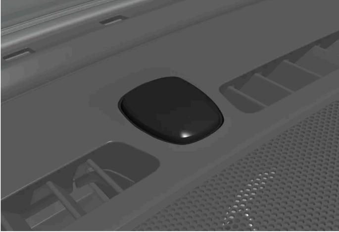
El indicador de bloqueo y alarma está situado en el centro del panel de instrumentos, cerca del parabrisas.
