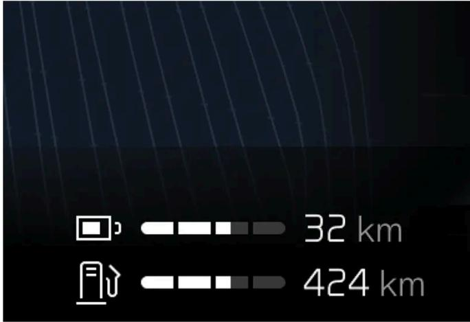
La autonomía estimada se visualiza en la pantalla del conductor.
