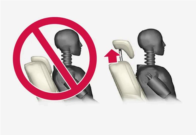
El reposacabezas de la plaza central debe ajustarse en función de la altura del pasajero para que, a ser posible, cubra toda la parte trasera de la cabeza. Suba el reposacabezas manualmente según sea necesario.
