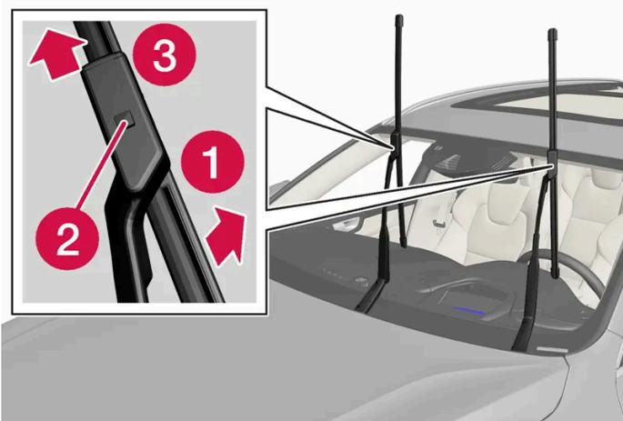
Despliegue el brazo del limpiaparabrisas cuando se halle en posición de servicio. El modo revisión se activa y desactiva a través de la pantalla central cuando el automóvil está detenido y los limpiaparabrisas no están funcionando.
