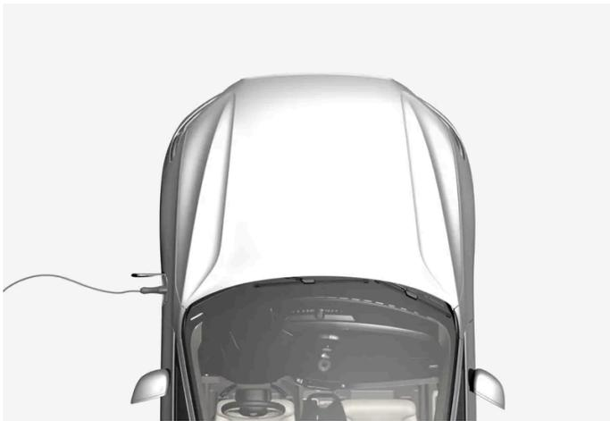
La batería híbrida se carga a través del cable de carga pero también con frenadas suaves y con el freno motor en la posición de cambio B. La batería híbrida puede cargarse también con el motor de combustión del vehículo. La batería de arranque del automóvil se carga al cargar la batería híbrida.
