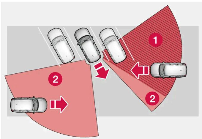
Dentro de un espacio de aparcamiento en ángulo, los sensores de uno de los lados pueden estar completamente bloqueados.
