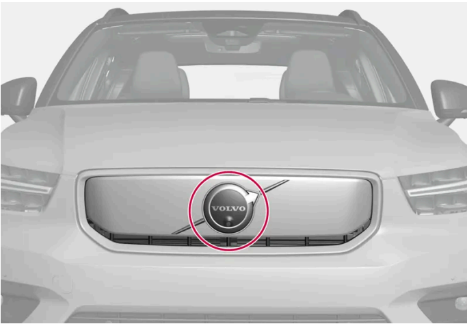
Ubicación de la unidad delantera de radar
