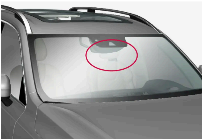
Ubicación de la unidad de cámara delantera
