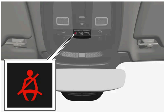
Aviso luminoso en la consola de techo.
