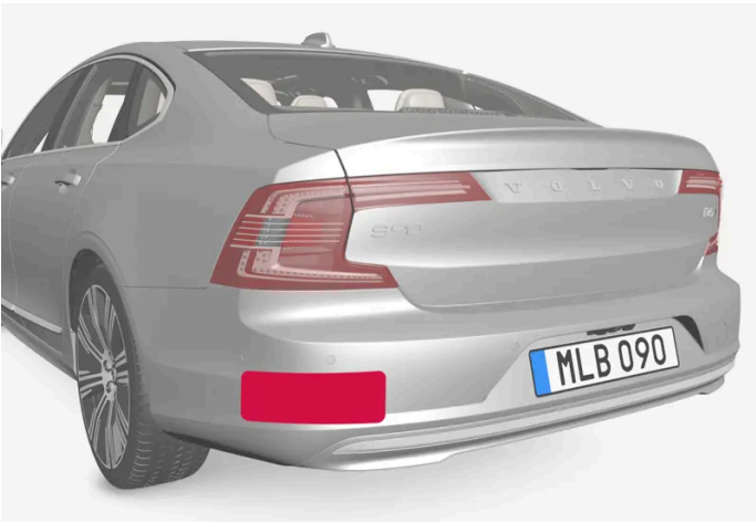
Ubicación de unidades de radar traseras
