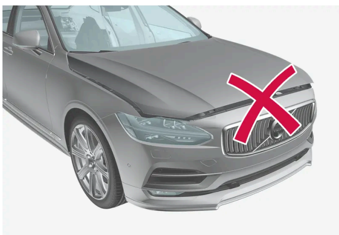
El capó no está completamente cerrado.
