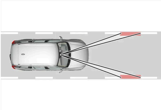
El sistema Driver Alert Control lee el emplazamiento del automóvil dentro del carril.
