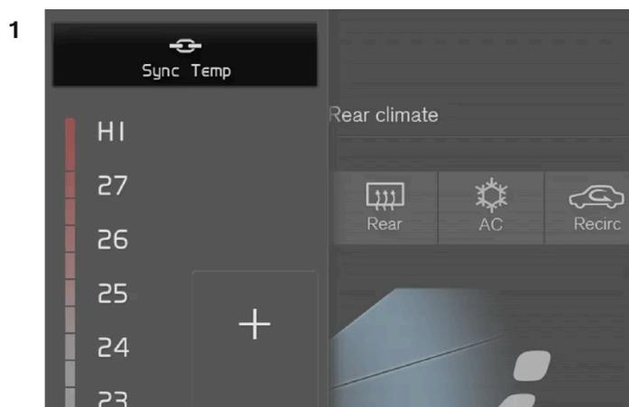
Botón de sincronización en el control de temperatura en el lado del conductor.
