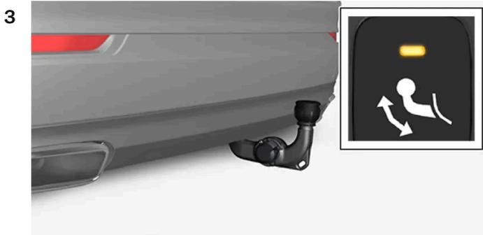
Lleve el enganche para remolque a su posición final donde se fija y se bloquea. La luz de indicación se enciende con luz fija de color naranja.
