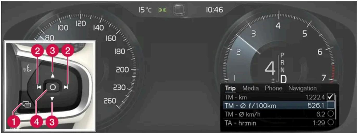
Menú de aplicaciones y teclado derecho del volante. La imagen es esquemática.
