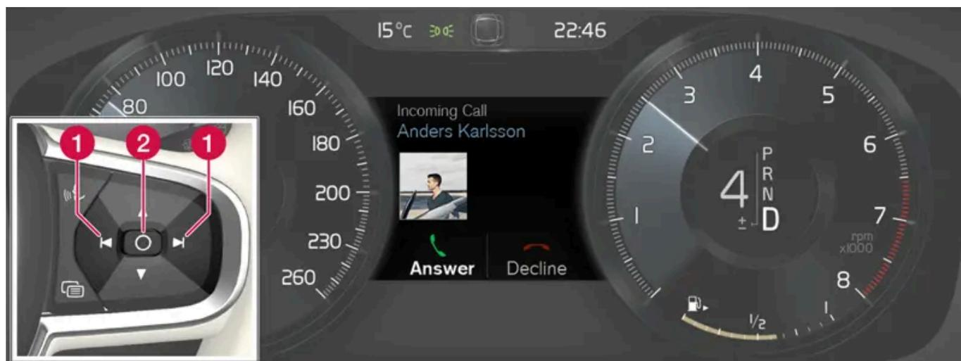
Ejemplo de mensaje en la pantalla del conductor<sup>[2]</sup> y teclado derecho del volante. La imagen es esquemática. Los detalles pueden variar según el modelo de automóvil.
