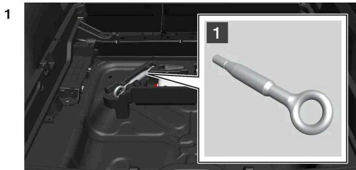
1 Saque la anilla de remolque que está en el taco de gomaespuma situado debajo del suelo en el compartimento de carga.
