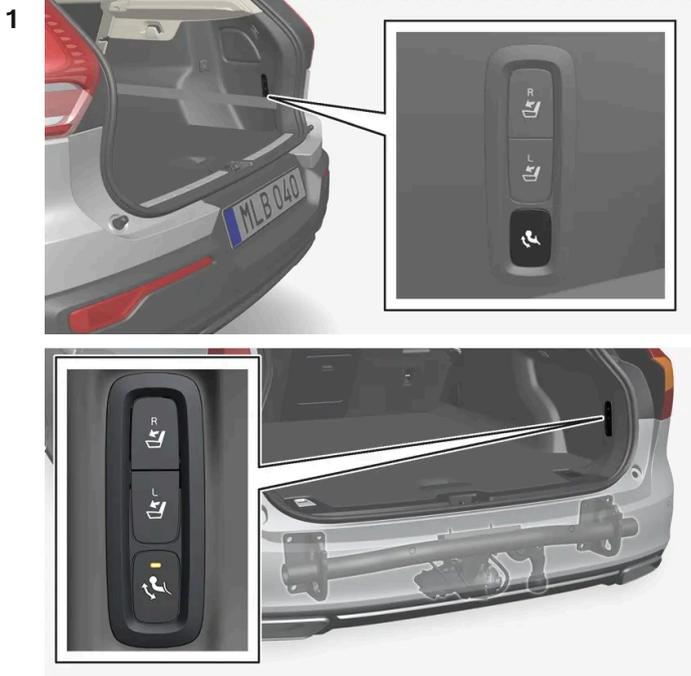
Abra el portón trasero. El botón para plegar y desplegar el enganche para remolque está situado en el lado derecho de la parte trasera del compartimento de carga. La luz de indicación del botón debe encenderse con luz fija de color naranja para que esté activa la función de despliegue.
