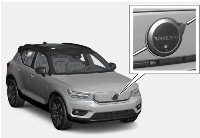
Esta cámara puede ser de utilidad al salir al tráfico con visión limitada hacia los lados, por ejemplo, cuando se sale de un garaje. Está activa a velocidades de hasta 25 km/h (16 mph). Después la cámara frontal se apaga.
