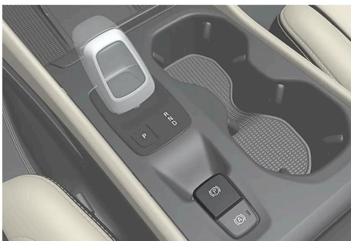
Cuando actúa el freno de estacionamiento eléctrico, se oye un ligero sonido de motor eléctrico. El sonido se oye también durante las funciones automáticas de control del freno de estacionamiento.
