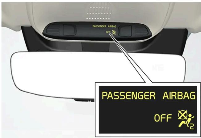
➤ En la consola del techo aparece un mensaje de advertencia y un símbolo para indicar que el airbag del asiento del acompañante está desconectado.
