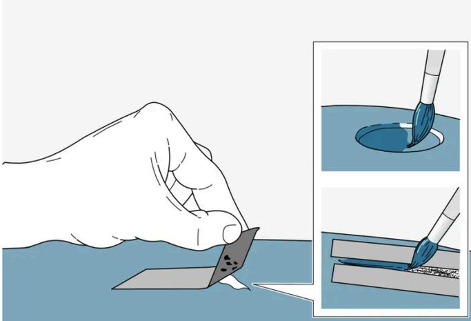
Si el daño no ha llegado al metal, puede aplicarse pintura para retoques directamente después de limpiar la superficie.
