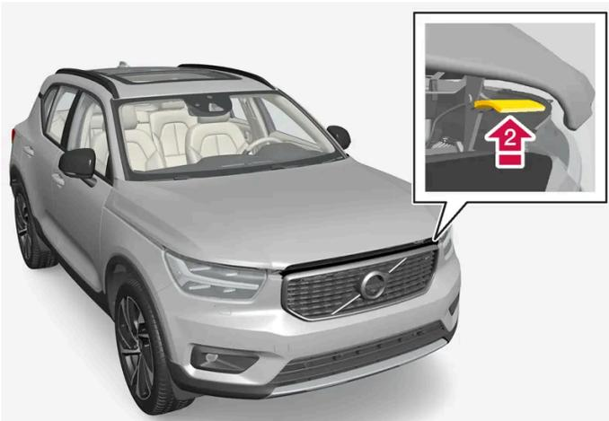
➔ Desplace la palanca debajo del capó hacia arriba para liberar el capó del gancho de cierre y levante el capó.
