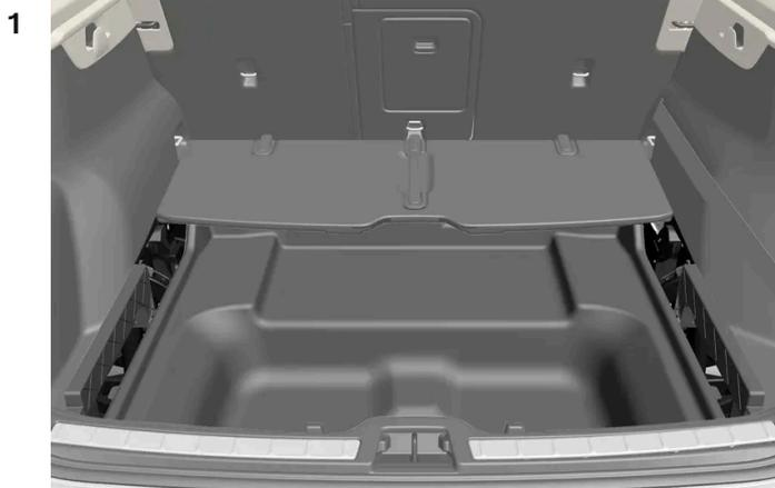
Pliegue el piso plegable del compartimento de carga para colocar la bandeja con la parte superior vuelta hacia abajo y la parte posterior hacia delante.
