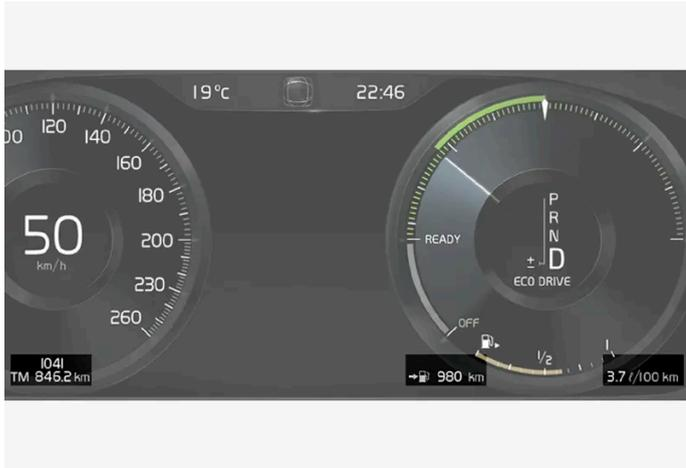
Ejemplo de información del ordenador de a bordo en la pantalla del conductor. La imagen es esquemática. Los detalles pueden variar según el modelo de automóvil.
