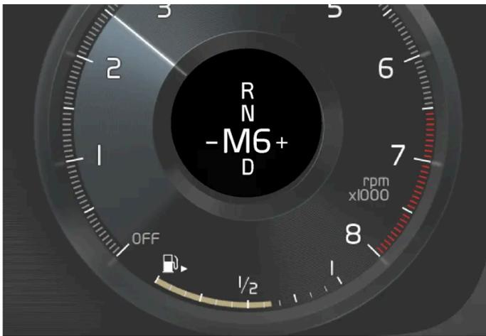
Vista general de la posición de cambio manual en la pantalla del conductor.
