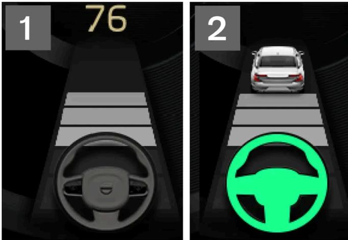
**2** Cuando el símbolo de volante en la pantalla del conductor se enciende, entonces Pilot Assist le está ayudando a conducir.
