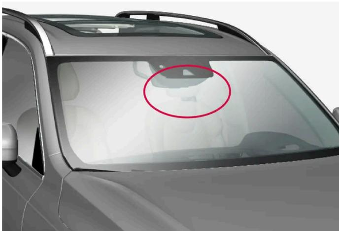
Ubicación de la unidad de radar y cámara delantera
