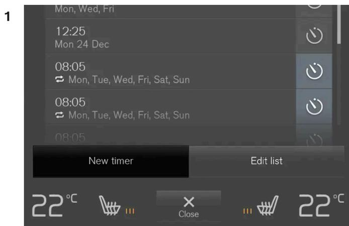
Botón para añadir un ajuste de hora en la pestaña **Climatización Aparcamiento** en la vista de climatización.
