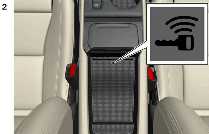
Coloque la llave sobre el símbolo de llave en el lector de seguridad del compartimento de la consola del túnel.
