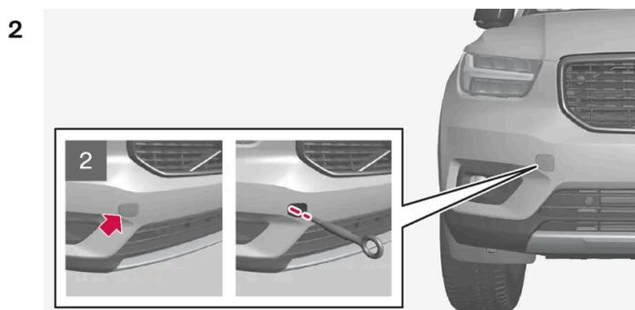
2 Delante: Retire la tapa de protección – presione sobre la tapa.
