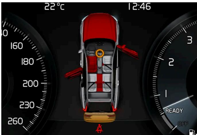
Gráfico en la pantalla del conductor con diferentes tipos de advertencias. El color de la advertencia de puertas y portón trasero depende de la velocidad del vehículo.
