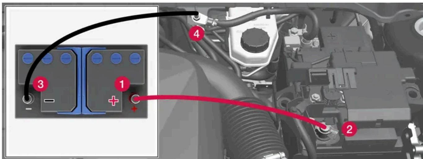
Puntos de carga para asistencia de arranque desde el vehículo propio. El aspecto del compartimento del motor puede variar en función del modelo de automóvil y del nivel de equipamiento.
