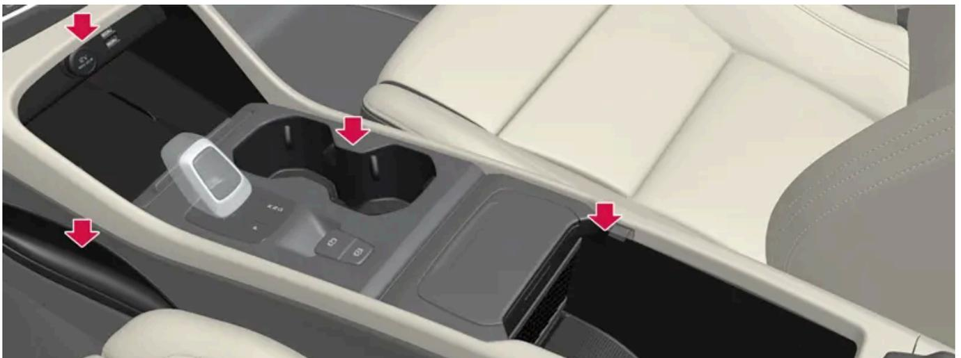
Compartimento junto a espacio para las piernas, toma eléctrica y puertos USB\* sobre el cargador telefónico inalámbrico\*, portavasos y compartimento bajo el apoyabrazos en la consola central.
