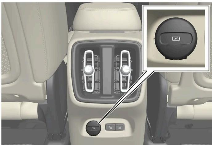
Puertos USB\* (tipo C) en la parte trasera de la consola del túnel para cargar, por ejemplo, teléfonos y tabletas<sup>[1]</sup>.
