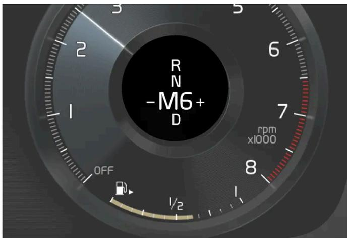
El indicador de cambio de marcha muestra la marcha de ese momento en la pantalla del conductor e indica la recomendación de cambiar a una marcha más larga con un símbolo + parpadeante.
