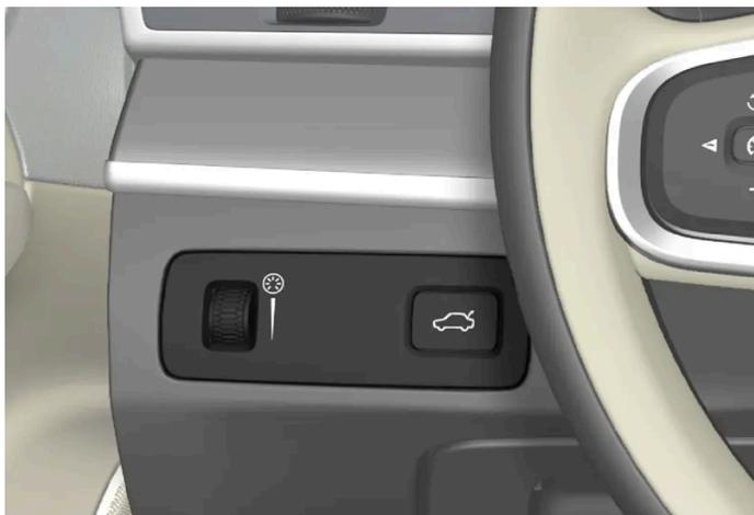
Rueda selectora (izquierda) para ajuste de la intensidad luminosa interior.
