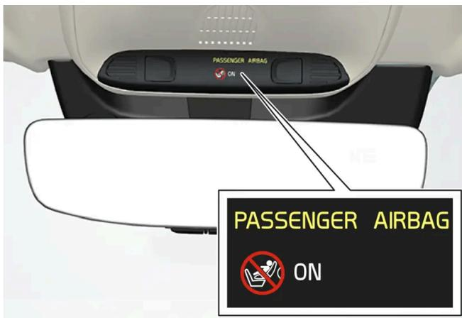
➤ En la consola del techo aparece un mensaje y un símbolo de advertencia indicando que el airbag del asiento del acompañante está conectado.
