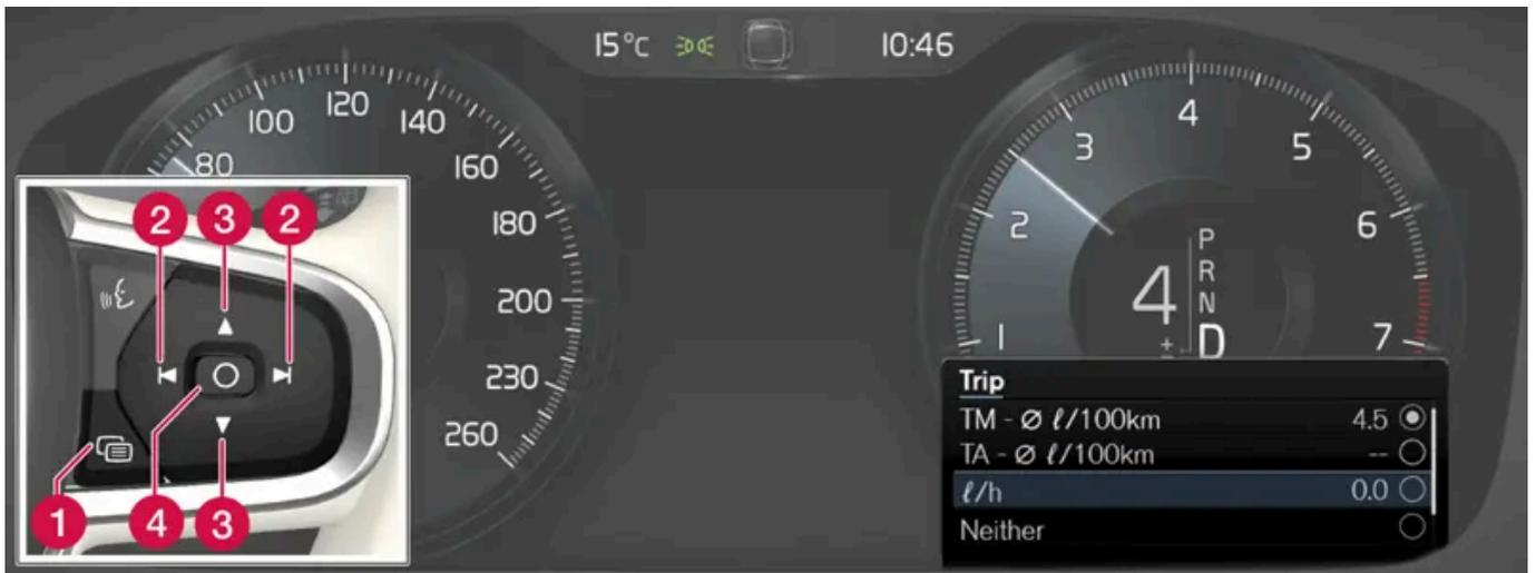
Abra y navegue en el menú de aplicaciones<sup>[1]</sup> con el teclado derecho del volante.
