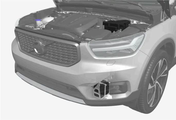
La batería de apoyo de 12 V está ubicada en la parte inferior del compartimento del motor. Aquí aparece también la batería de arranque (arriba).
