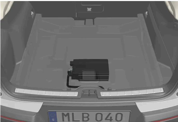
Sin embargo, si el automóvil es de tipo Mild Hybrid, contará con una batería de apoyo de 48 V situada a la izquierda del compartimento de carga. La batería solo puede manipularla un taller autorizado.
