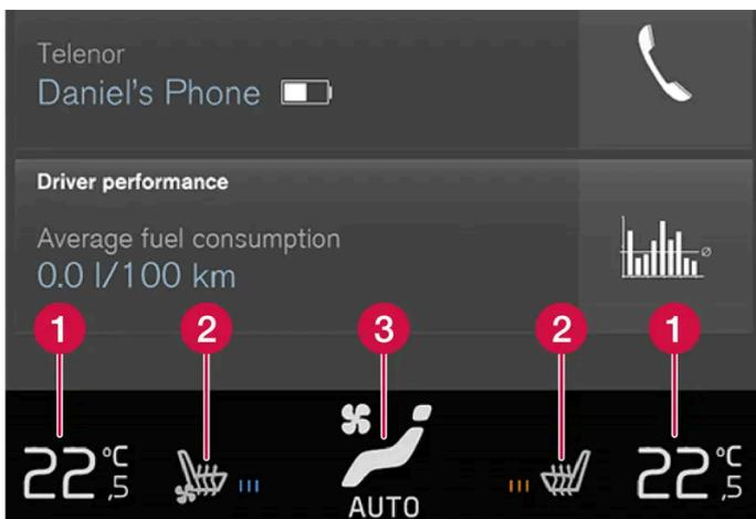
Barra de climatización con 2 zonas de climatización. La barra de climatización con 1 zona de climatización presenta algunas diferencias en la ubicación del control.
