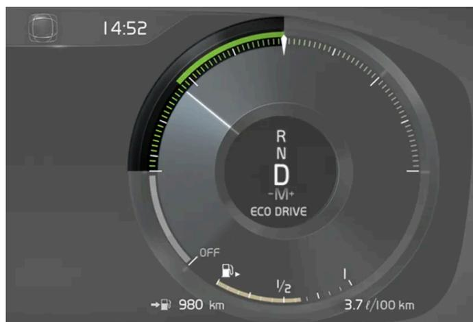
El medidor ECO indica el rendimiento de la conducción:
