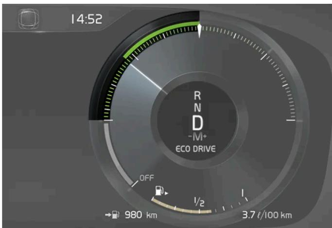
El medidor ECO indica el rendimiento de la conducción:
