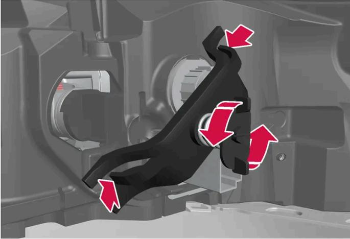
3. Desenrosque el tornillo resorte en sentido contrario al de las agujas del reloj, presione hacia dentro las presillas de los lados y quite el puente de sujeción. Lo más sencillo es dejar el tornillo en el propio puente de sujeción.
