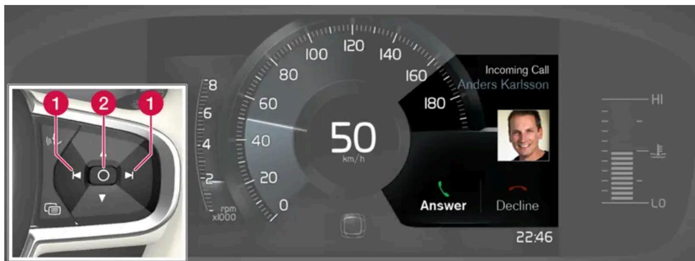
Ejemplo de mensaje en la pantalla del conductor<sup>[1]</sup> y teclado derecho del volante. La imagen es esquemática. Los detalles pueden variar según el modelo de automóvil.
