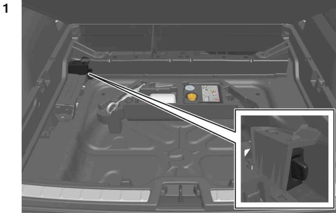
Coloque una tarjeta SIM personal en el soporte situado bajo el piso del maletero.
