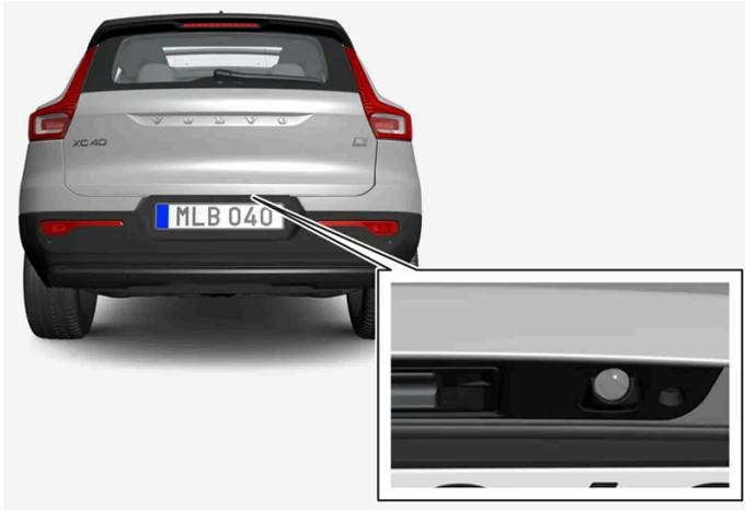
La cámara trasera muestra una zona amplia detrás del vehículo. En algunos modelos, puede verse también una parte del para-choques y la bola de remolque.
