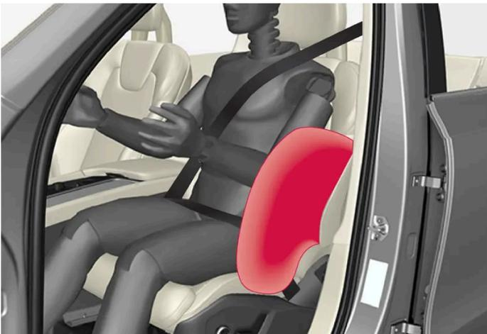
Los airbags laterales están montados en las estructuras exteriores de los asientos delanteros y ofrecen protección al conductor y al acompañante del asiento delantero.
