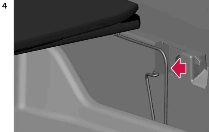
Siga manteniendo levantado el piso de carga y presione el muelle de enganche del otro lado por donde indica la flecha.
