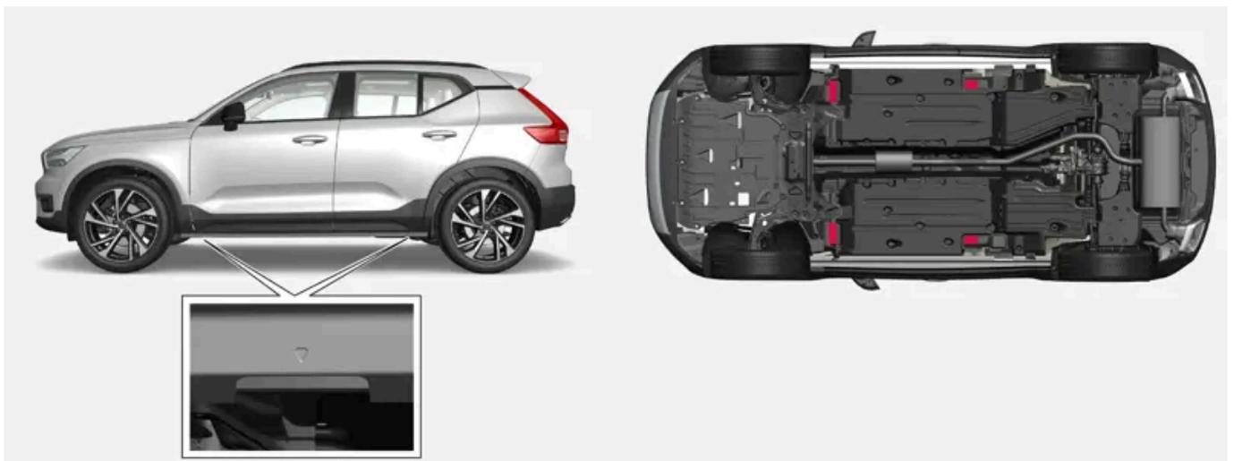
Los triángulos en la cubierta de plástico indican dónde están situados las fijaciones del gato o los puntos de elevación (de color rojo).
