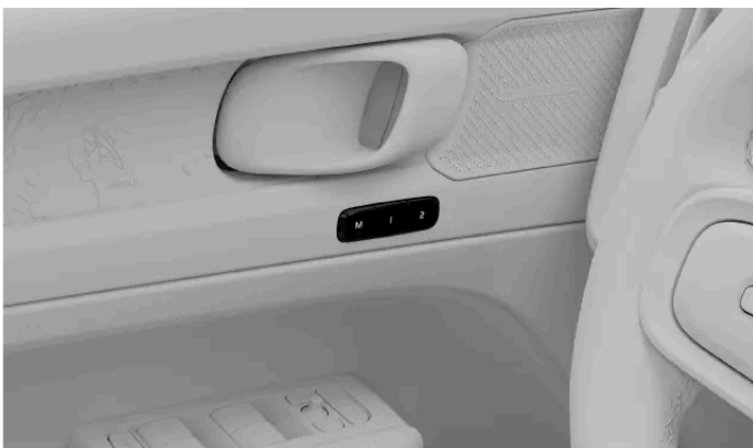
Istuimen esiasetuspainikkeiden sijainti
