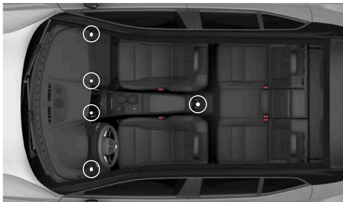
Säädettävien tuuletussuulakkeiden sijainnit
