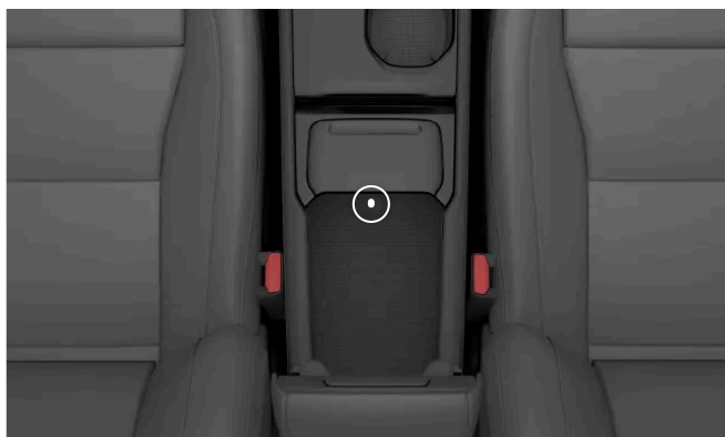
Varalukijan sijainti tunnelikonsolin säilytyslokerossa
