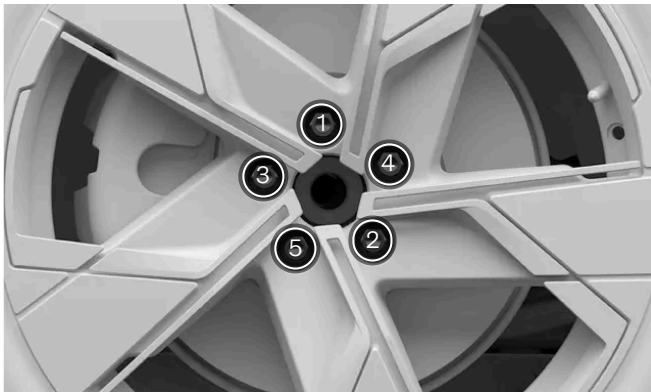
Kiristä pyörän kiinnittimet ristikkäin.
