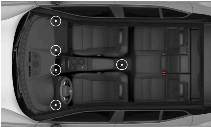
Säädettävien tuuletussuulakkeiden sijainnit
