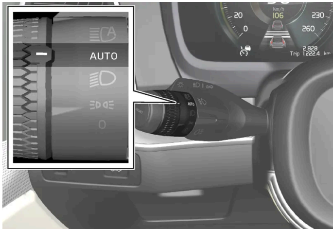
Ohjauspylvään vivun kiertorengas asennossa AUTO .
