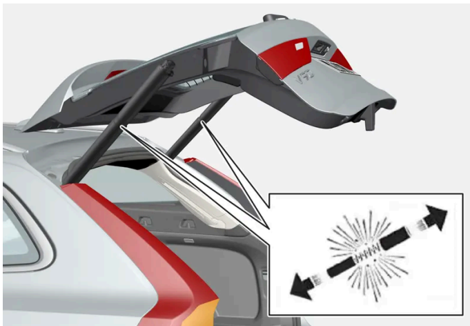
Sähkötoimisen takaluukun esijännitetyt jouset.
