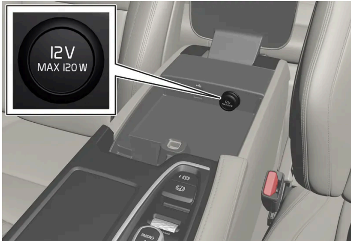
12 V:n sähköliitântä tunnelikonsolissa, etuistuin.
