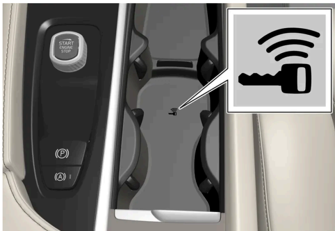
Varmistuskäynnin sijainti tunnelikonsolissa.
