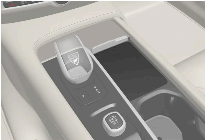
Langaton puhelinlaturi tunnelikonsolissa.
