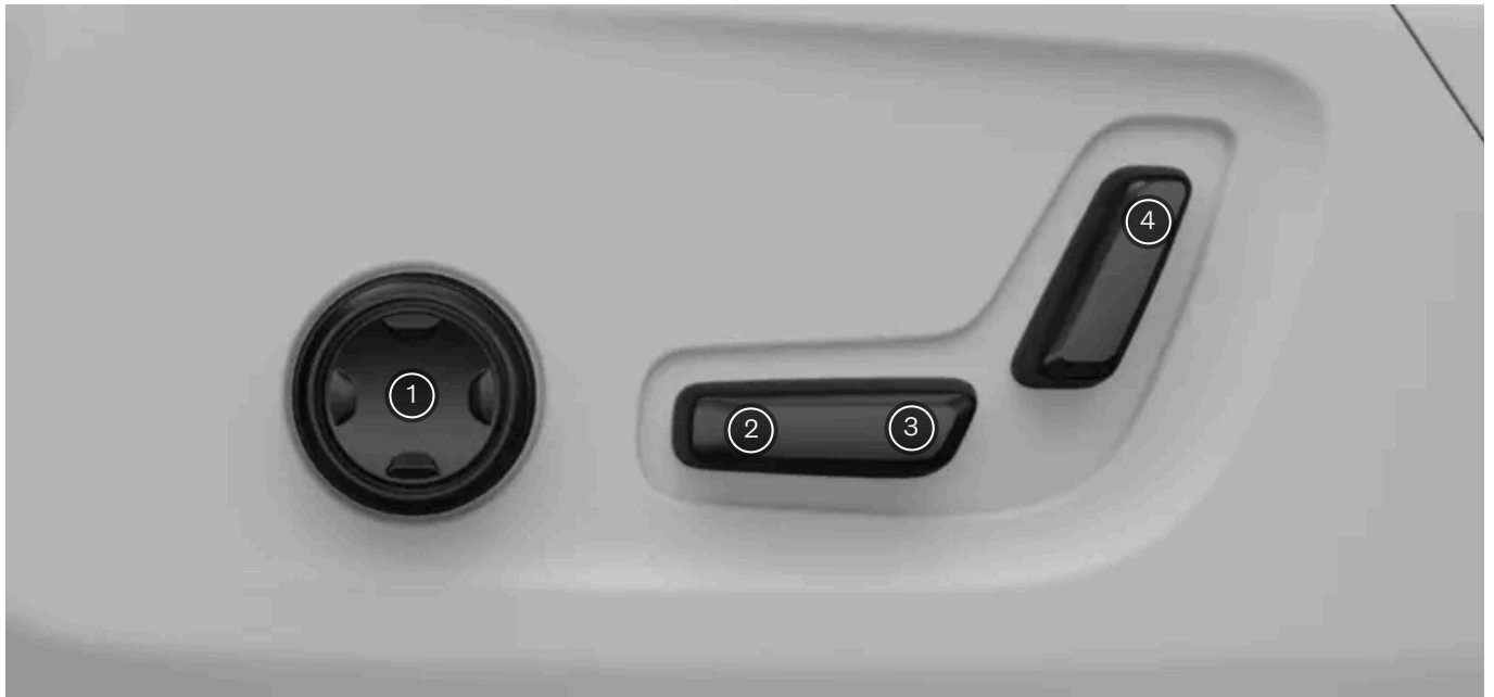
Istuimen sivussa olevat säätimet
