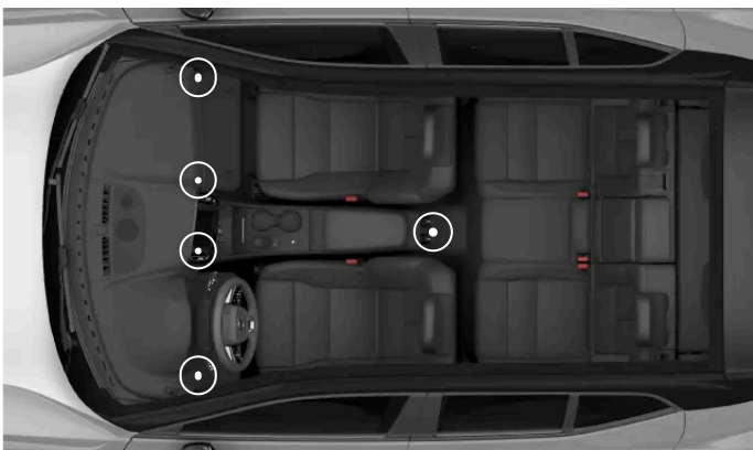
Säädettävien tuuletussuulakkeiden sijainnit
