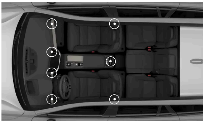
Säädettävien tuuletussuulakkeiden sijainnit
