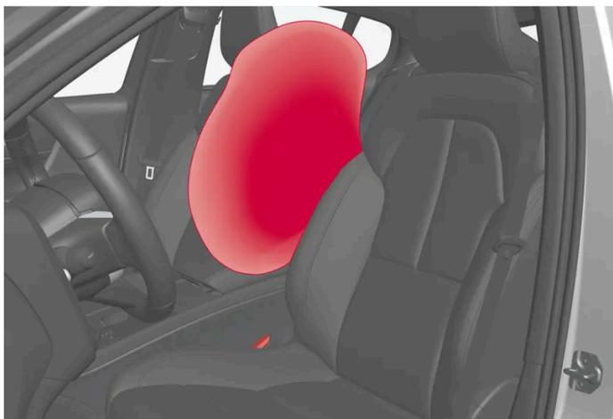
Les coussins gonflables latéraux intérieurs montés sur la face intérieure des dossiers des sièges avant contribuent à protéger le conducteur et le passager avant. Le siège porte l'inscription AIRBAG.
