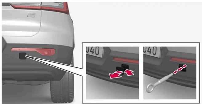
Avant: Retirer le cache : appuyez sur le cache. Le cache se balance sur son axe médian et peut alors être détaché.
