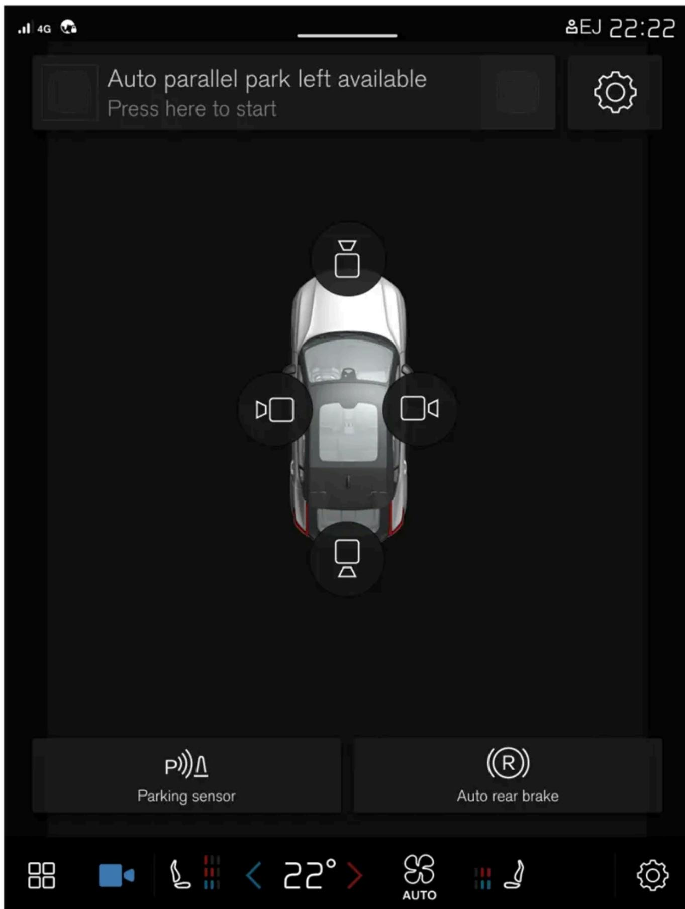
La vue Caméra affiche les images des caméras d'aide au stationnement (PAC<sup>[1]</sup>), qui donnent une vue à 360° ainsi qu'une vue séparée pour les quatre caméras : arrière, avant, gauche ou droite.
