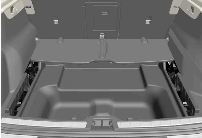
Repliez le plancher du compartiment à bagages vers l'avant pour ranger la plage arrière avec la face supérieure orientée vers le bas et sa partie arrière vers l'avant.
