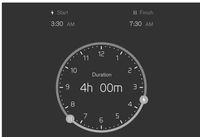
Sélectionnez **Charge de la batterie** → **Régler la minuterie** à l'écran central puis activez la planification dans **Programmer la charge**. Utilisez les commandes ⚡ et || pour spécifier les horaires de début et de fin de la recharge.
