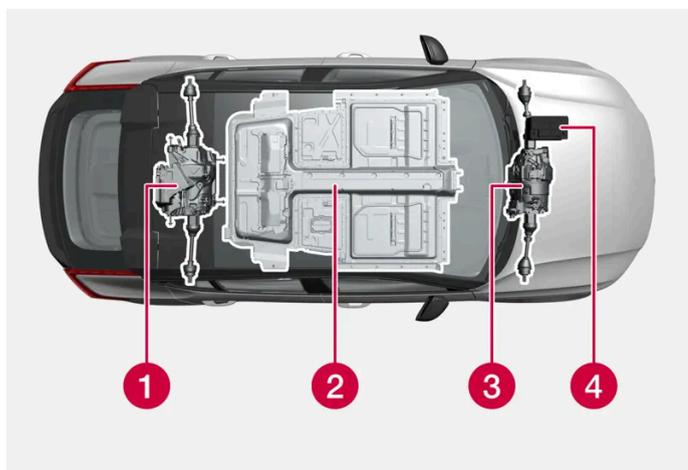
**1** Moteur électrique – Le moteur électrique de la voiture propulse la voiture et recycle l'énergie de freinage en énergie électrique.
