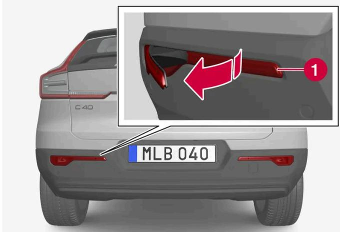
Le feu antibrouillard arrière est uniquement placé sur le côté conducteur.
