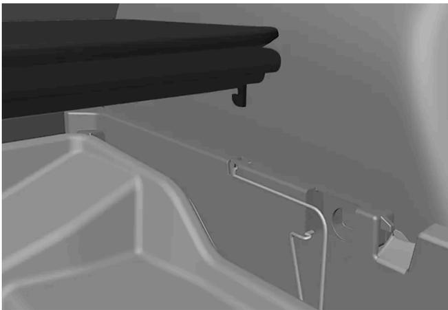
Le plancher du compartiment à bagages peut être replacé avec précaution sur les ressorts de verrouillage sans être verrouillé.
