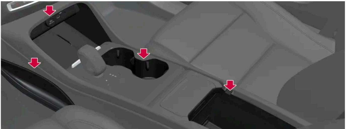
Compartiment de rangement dans l'espace pour les jambes, prise électrique et ports USB au-dessus du chargeur de téléphone par induction\*, porte-gobelets et rangement sous l'accoudoir de la console de tunnel.
