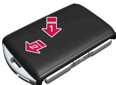
Remontez la coque de la partie arrière dans l'ordre inverse du démontage. La coque de la partie arrière n'a pas de logotype. Mettez en place la coque. Un clic doit se faire entendre. Poussez-la ensuite les derniers millimètres jusqu'à sa position d'origine.
