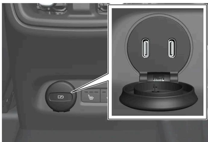
Ports USB (type C) de la console centrale, banquette arrière
