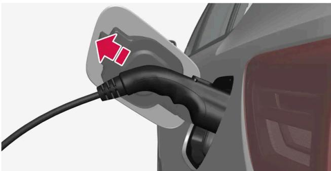
Débranchez le câble de recharge de la prise de recharge de la voiture et fermez la trappe.
