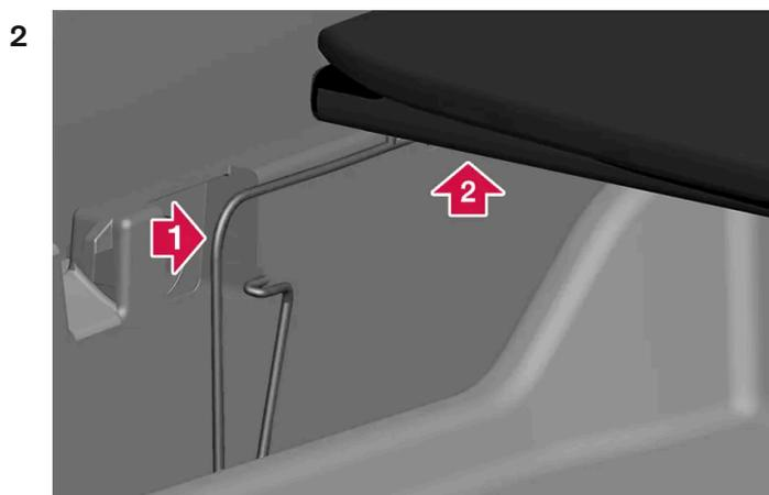
**1** Appuyez sur le ressort de verrouillage à l'endroit indiqué par la flèche jusqu'à la butée. Maintenez enfoncé.
