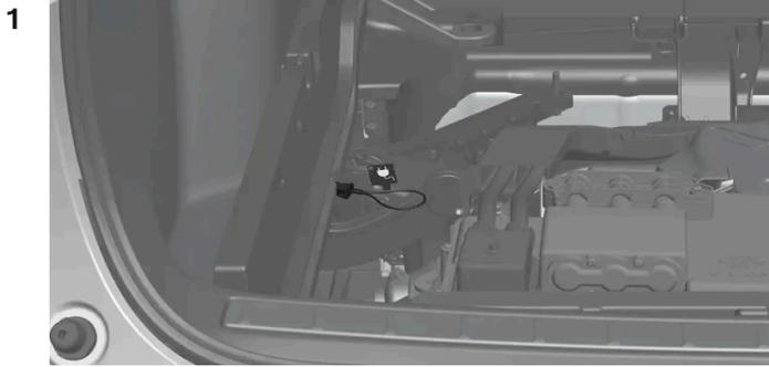
Ouvrez le compartiment à bagages de la voiture et relevez le plancher du compartiment à bagages. Retirez le panneau de plancher surbaissé.
