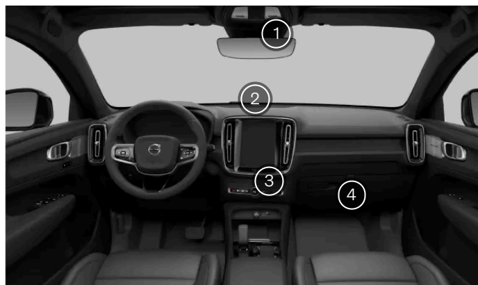
Capteurs intérieurs de climatisation
