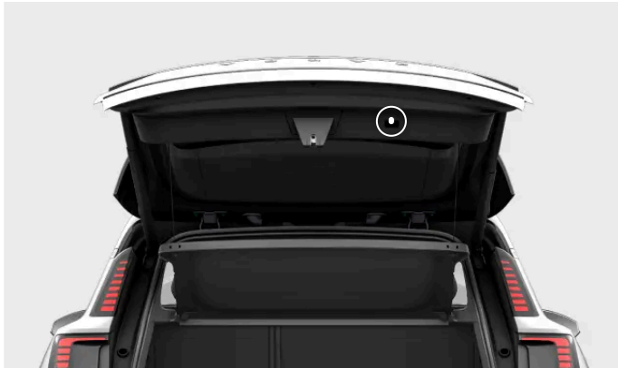
Position du bouton de fermeture du coffre
