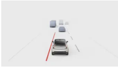
Les interventions de l'assistance de maintien sur la voie sont indiquées par une ligne pleine et rouge.
