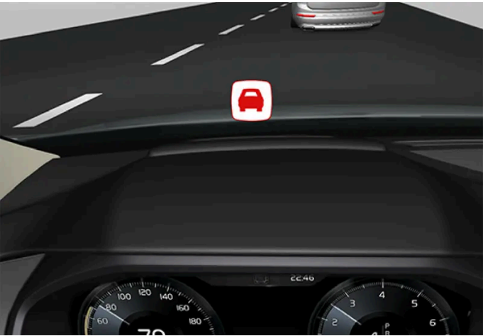
Le témoin d'avertissement de City Safety clignote pour attirer l'attention du conducteur en cas de risque de collision.
