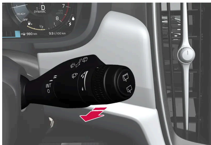
Fonction lave-glace, levier droit au volant
