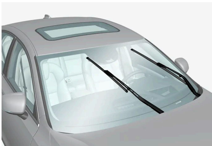
Balais d'essuie-glace en position d'entretien.
