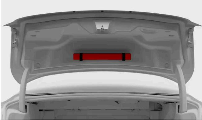
Le triangle de présignalisation est rangé à l'intérieur du hayon/couvercle de coffre. Ouvrez le compartiment en tournant les manettes à la verticale, puis en les tirant.
