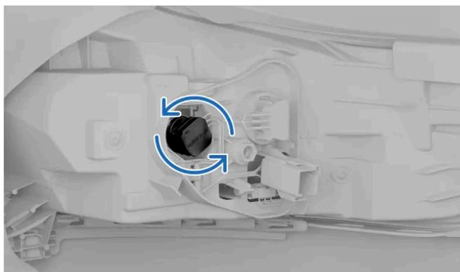
Tournez la douille noire dans le sens inverse des aiguilles d'une montre et retirez-la.
