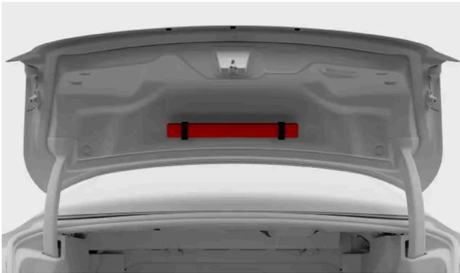
Le triangle de présignalisation est fixé à l'intérieur du hayon/couvercle de coffre par deux attaches.
