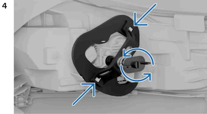
Dévissez la vis à ressort en tournant dans le sens inverse des aiguilles d'une montre. Laissez la vis dans l'arceau de support afin de pouvoir la retrouver en cas de besoin.
