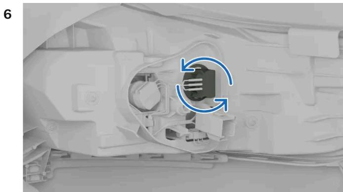
Tournez la douille grise dans le sens inverse des aiguilles d'une montre et retirez-la.
