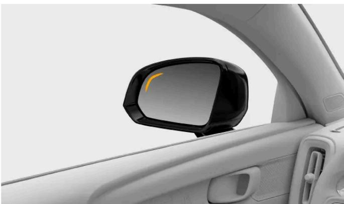
Lorsqu'un véhicule est détecté dans votre angle mort ou en approche, un témoin apparaît sur le rétroviseur extérieur.
