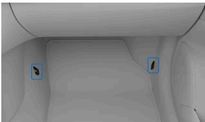
Les points de fixation de sangle inférieure pour le siège passager avant sont situés sur les côtés de la cave à pieds du siège.
