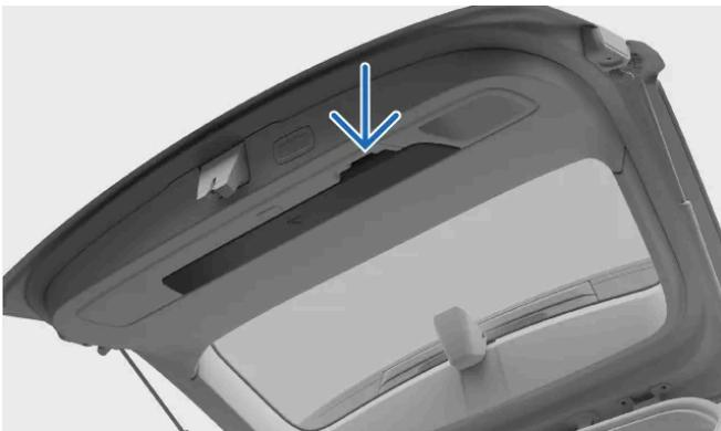
Le triangle de présignalisation est rangé à l'intérieur du hayon/couvercle de coffre. Tirez sur la poignée pour l'ouvrir.
