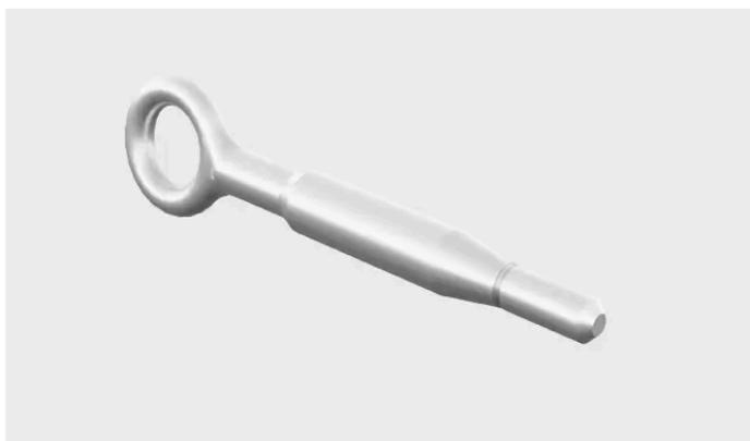
L'œillet de remorquage peut être fixé au pare-chocs de la voiture. Il peut également être utilisé pour arrimer des objets placés sur le toit qui dépassent du toit.
