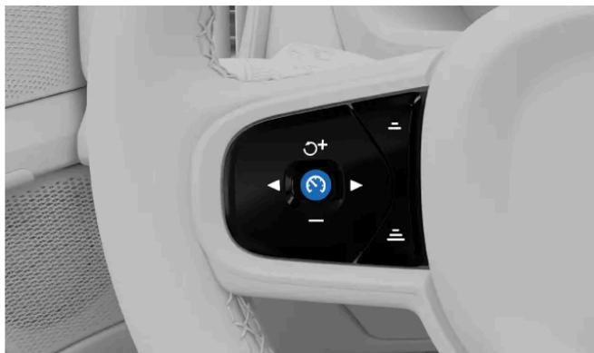
Lorsque Pilot Assist peut être activé en toute sécurité, appuyez sur le bouton
