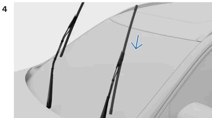
Vérifiez que le balai côté conducteur est plus long que celui du côté passager. Faites glisser le balai d'essuie-glace sur le bras d'essuie-glace. Vérifiez que la goupille du bras d'essuie-glace entre dans l'orifice du balais d'essuie-glace. Poussez le balai dans le bras d'essuie-glace jusqu'à ce qu'un déclic se fasse entendre.
