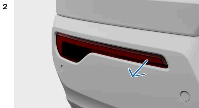
Insérez un tournevis derrière le petit côté le plus étroit du feu antibrouillard et faites levier pour l'extraire.
