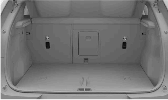
La position des points de fixation de sangle supérieure pour les sièges arrière est indiquée par le symbole de sangle supérieure.
