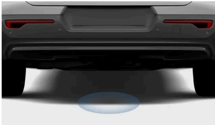
Le capteur détecte les mouvements sous le pare-chocs arrière. Tout mouvement détecté déverrouille le coffre.
