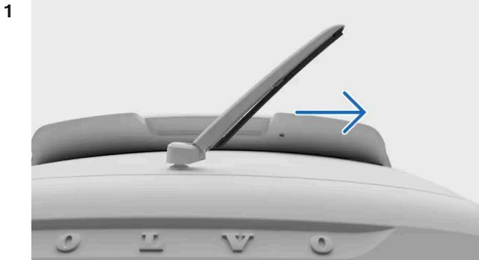
Agrippez le centre du bras d'essuie-glace et soulevez-le de la lunette arrière. Vous ressentirez peut-être une légère résistance à mi-chemin : il s'agit de la position de verrouillage. Le bras d'essuie-glace doit passer cette position de verrouillage pour ne pas se remettre en position sur la lunette arrière.
