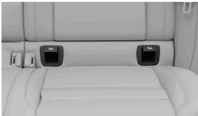
Position des points de fixation ISOFIX pour les sièges arrière extérieurs
