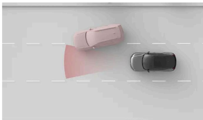
La largeur de la zone de détection du radar avant est limitée. Si un autre véhicule vous fait une queue-de-poisson, la détection peut se produire assez tardivement et entraîner une réponse soudaine de votre voiture.
