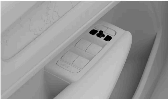
Commandes de réglage des rétroviseurs extérieurs
