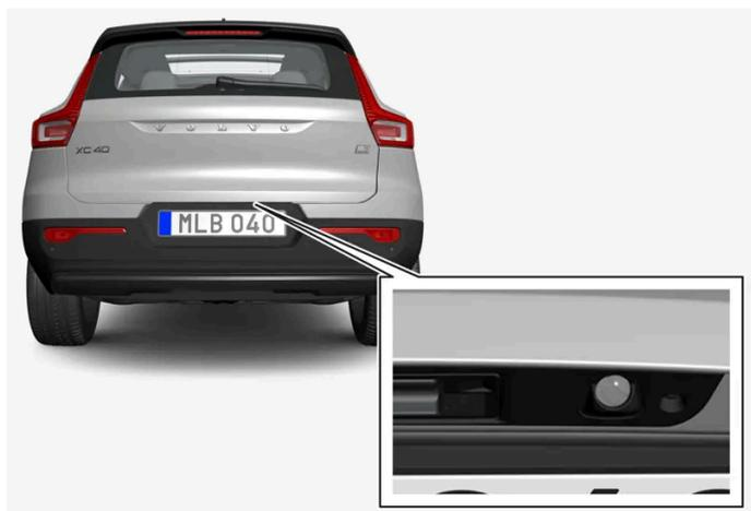
La caméra arrière est placée au-dessus de la plaque d'immatriculation.
