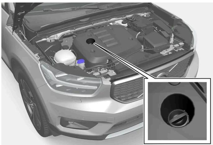
Tuyau de remplissage<sup>[1]</sup>,<sup>[2]</sup>
