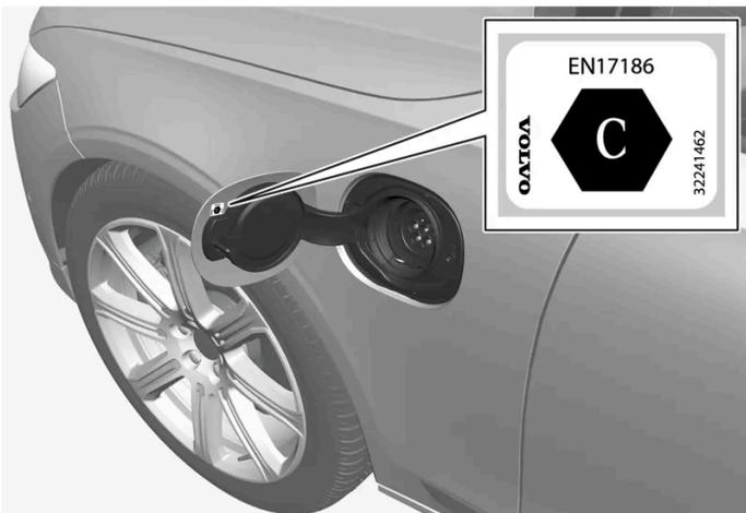
Un identifiant conforme à la norme CEN EN 17186 figure sur l'intérieur de la trappe de recharge.
