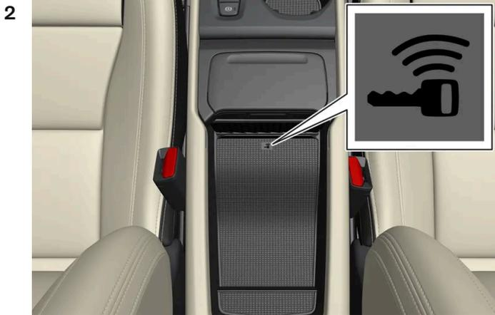
Placez la clé sur le symbole en forme de clé dans le lecteur de secours du compartiment de rangement de la console du tunnel.
