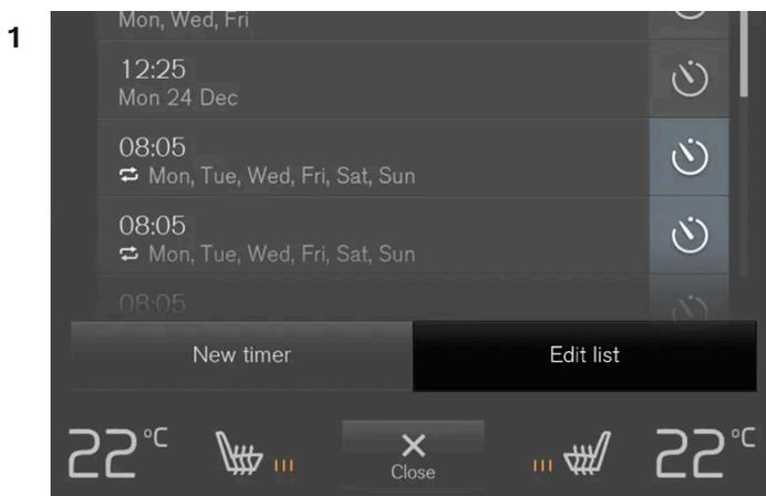
Bouton pour modifier la liste/enlever la programmation de minuterie dans l'onglet **Climatisation à l'arrêt** de la vue Climatisation.
