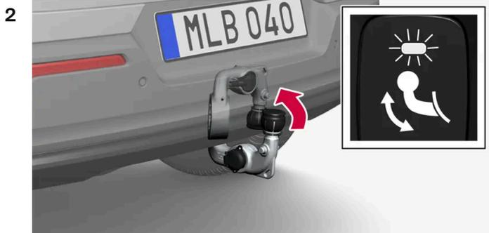
Verrouillez le crochet en le repoussant en position rentrée, où il se verrouillera.
