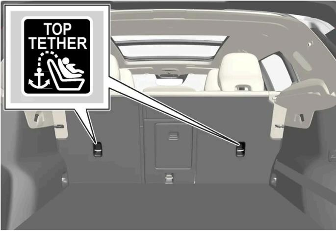
L'emplacement des points de fixation pour la banquette arrière est indiqué par des symboles sur la face arrière du dossier.
