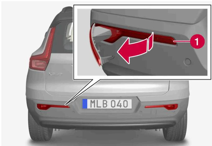
Le feu antibrouillard arrière est uniquement placé sur le côté conducteur.
