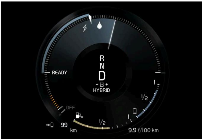
Le moteur électrique ne peut délivrer la puissance moteur demandée et le moteur à combustion démarre.
