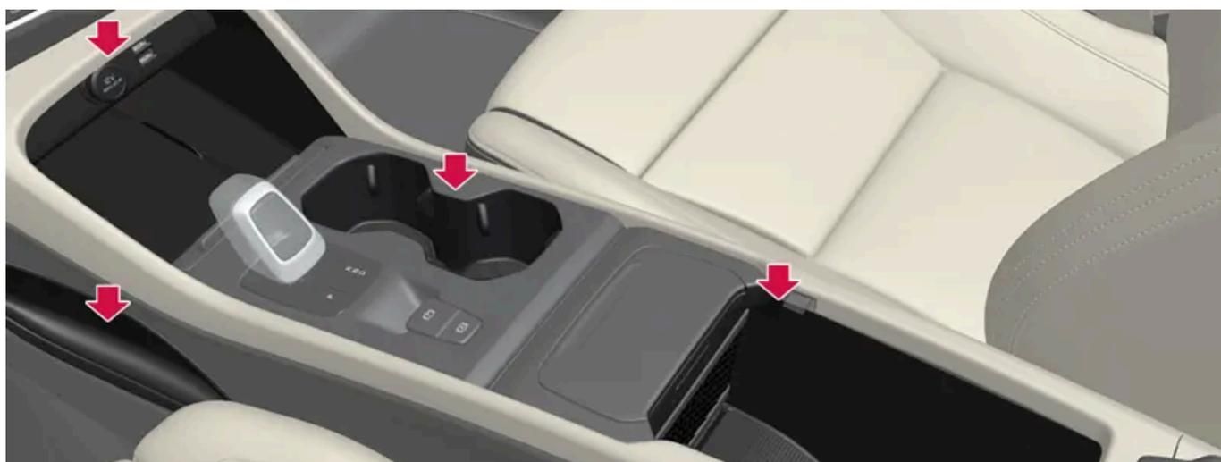
Compartiment de rangement dans l'espace pour les jambes, prise électrique et ports USB\* au-dessus du chargeur sans fil de téléphone\*, porte-gobelets et rangement sous l'accoudoir de la console de tunnel.
