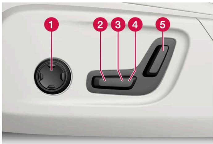
1 Pour activer et utiliser la commande de soutien lombaire, appuyez sur la commande quadridirectionnelle haut/bas/avant/arrière.
