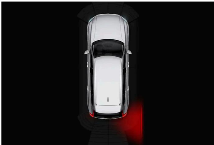
icône allumée pour Cross Traffic Alert sur le graphique **Assist. de stationnement semi-automatique** à l'écran.
