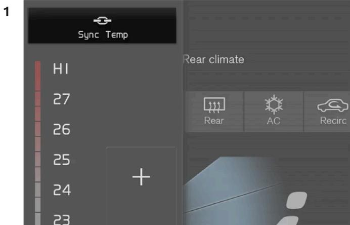
Bouton de synchronisation sur la commande de température du côté conducteur.
