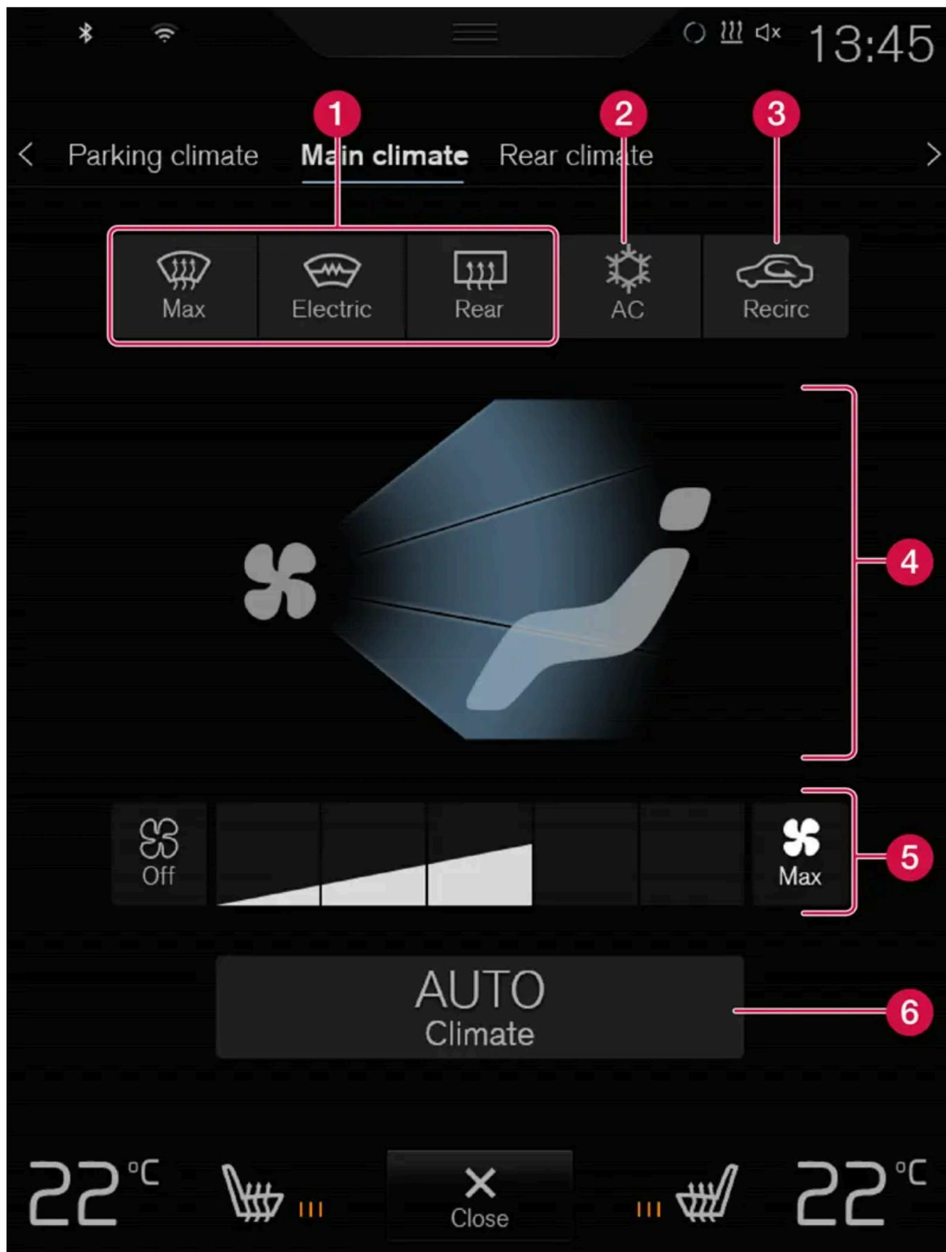
**1** Max, Électrique, Arrière - Commande de dégivrage des vitres et des rétroviseurs.
