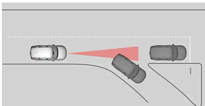
Si le véhicule cible qui précède change brusquement de direction, la circulation peut être arrêtée un peu plus loin.
