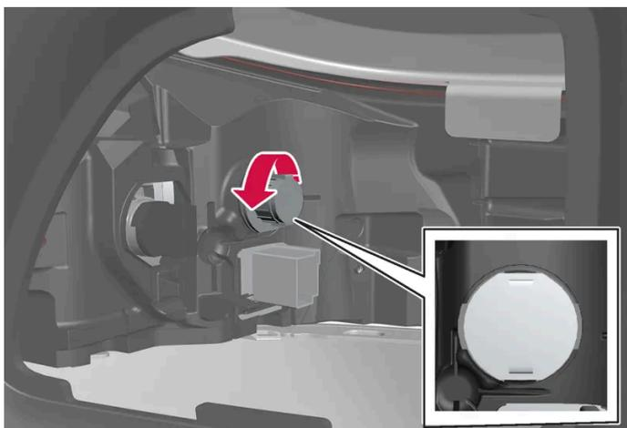
4. Détachez la douille grise en la tournant dans le sens horaire puis en tirant.
