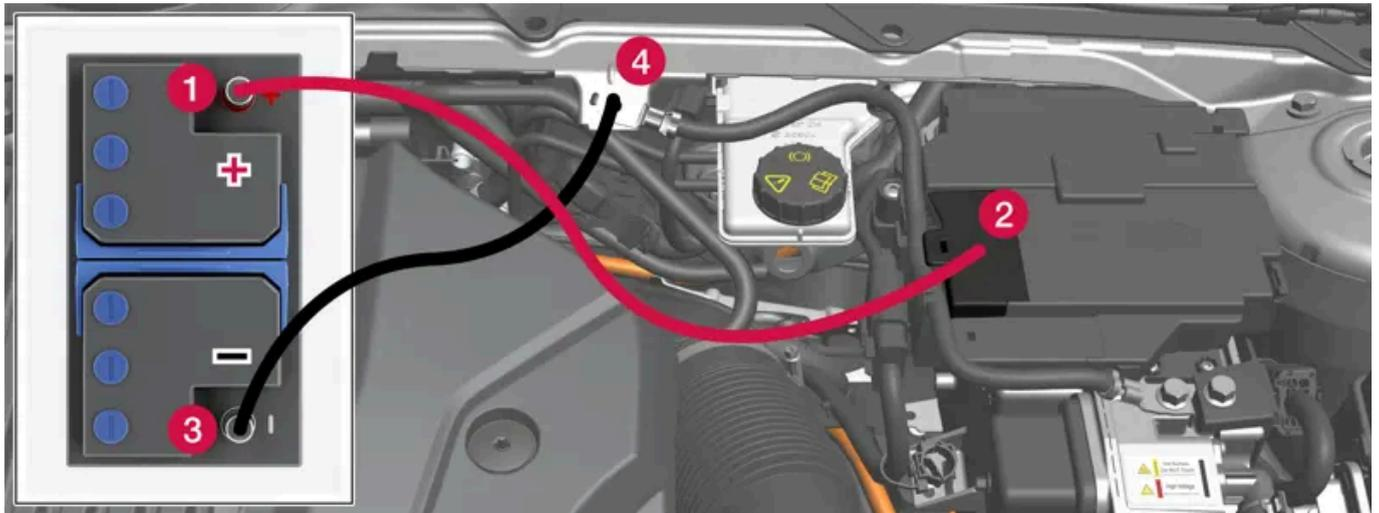
Points de charge pour le démarrage auxiliaire de la voiture. Le couvercle cache deux points de connexion. N'utilisez que celui qui se trouve le plus près de l'habitacle.
