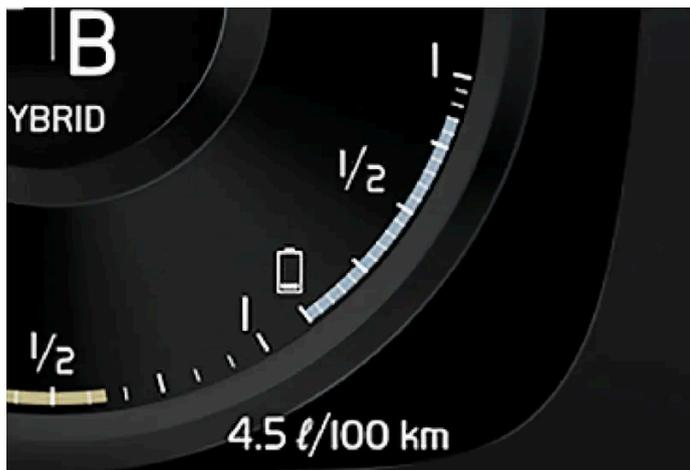
L'énergie de la batterie hybride est utilisée pour le moteur électrique, mais également pour refroidir ou réchauffer la voiture. L'ordinateur de bord calcule un kilométrage approximatif pour la quantité d'énergie disponible dans la batterie hybride.
