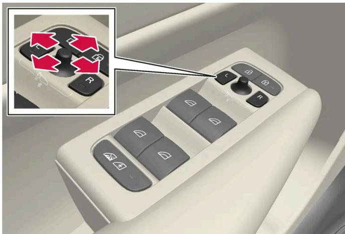
Commande des rétroviseurs extérieurs.
