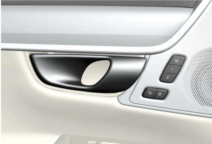
Poignée d'ouverture pour le déverrouillage alternatif d'une porte latérale<sup>[1]</sup>.
