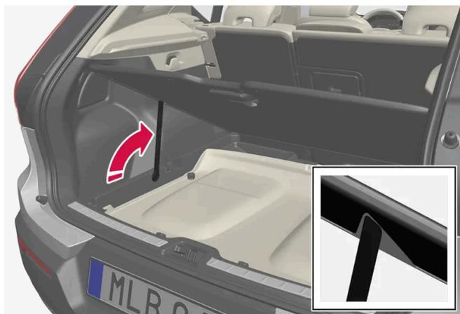
➤ Le plancher du compartiment à bagages est ainsi maintenu en position haute.
