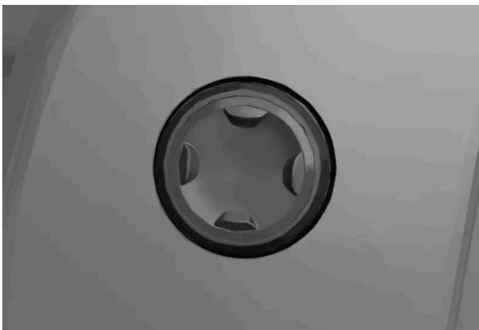
Bouton quadrirectionnel placé sur le côté du coussin d'assise du siège.
