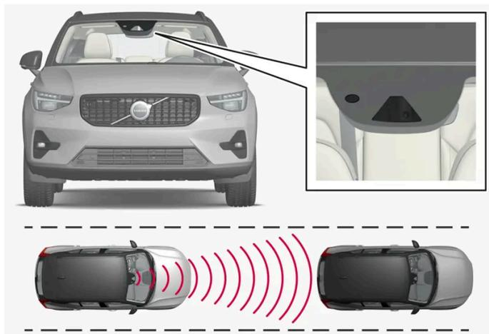
L'unité de caméra/radar mesure la distance au véhicule qui précède.
