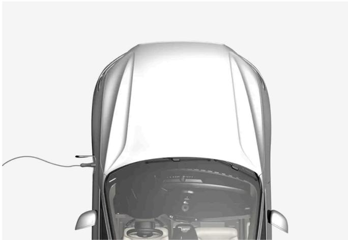
La batterie hybride est rechargée à l'aide d'un câble de recharge mais peut également être rechargée par les freinages légers et par le frein moteur en position de changement de rapport B. La batterie hybride peut également être chargée grâce au moteur à combustion de la voiture. La batterie de démarrage de la voiture est rechargée durant la recharge de la batterie hybride.
