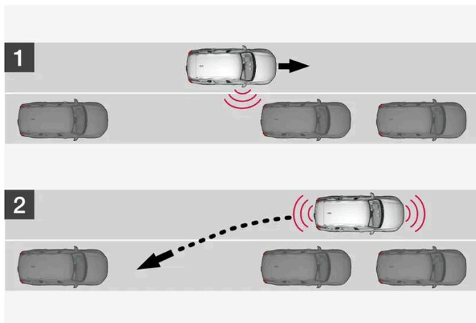
Principe pour le stationnement en créneau en reculant.
