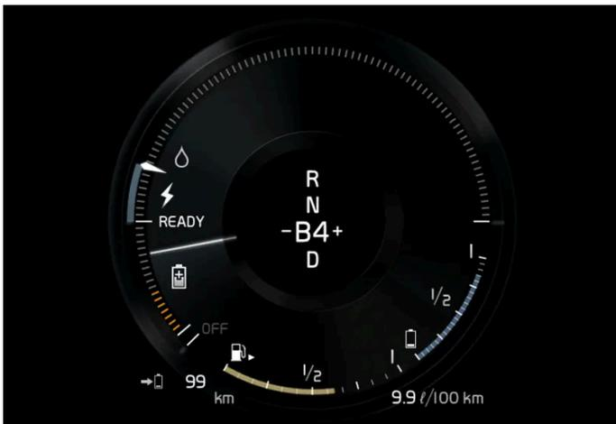
La voiture génère de l'énergie à la batterie et la batterie se recharge, lors d'une légère pression sur la pédale de frein ou d'un freinage moteur en descente par exemple.
