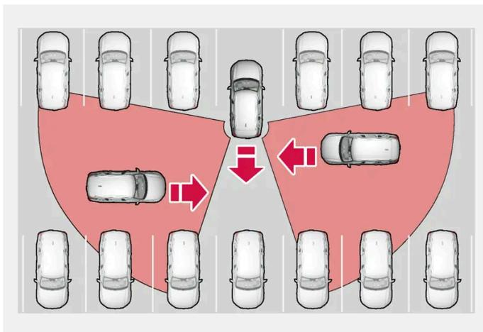
Exemple de zone où Cross Traffic Alert peut aider le conducteur à détecter un obstacle en marche arrière.
