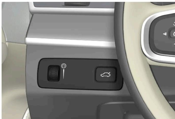
Molette (à gauche) de réglage de la luminosité intérieure.
