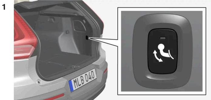
Ouvrez le hayon. Un bouton situé sur le côté droit à l'arrière dans le compartiment à bagages permet de sortir et de rentrer le crochet d'attelage. Un témoin sur le bouton doit s'allumer en orange pour permettre la sortie du crochet.
