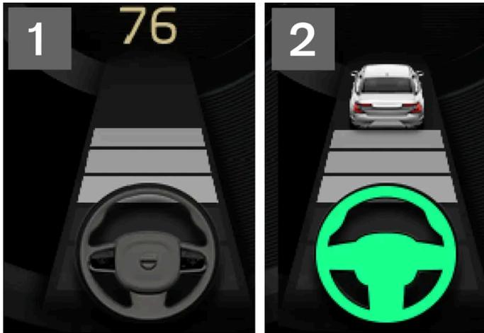
**2** Lorsque le symbole de volant sur l'écran conducteur est allumé, la fonction Pilot Assist est active.
