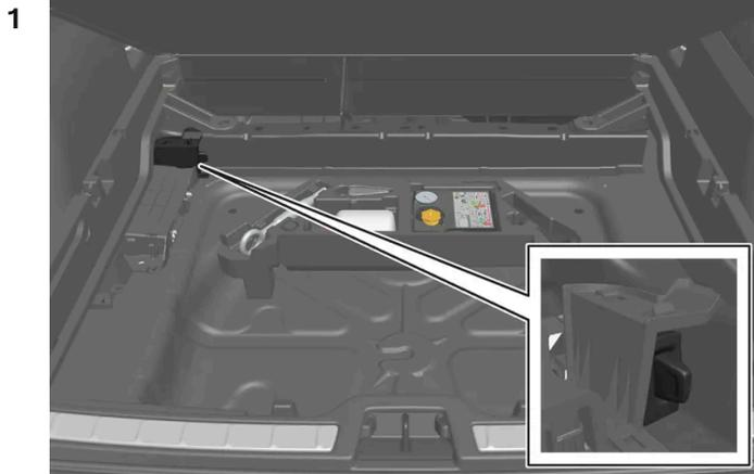
Placez une carte SIM dans le support situé sur le plancher du compartiment à bagages.
