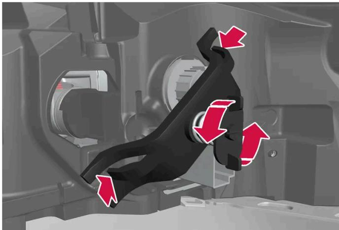
3. Retirez la vis à ressort en tournant dans le sens antihoraire, appuyez sur l'attache et retirez l'arceau de support. Le plus simple est de laisser la vis sur l'arceau de support.
