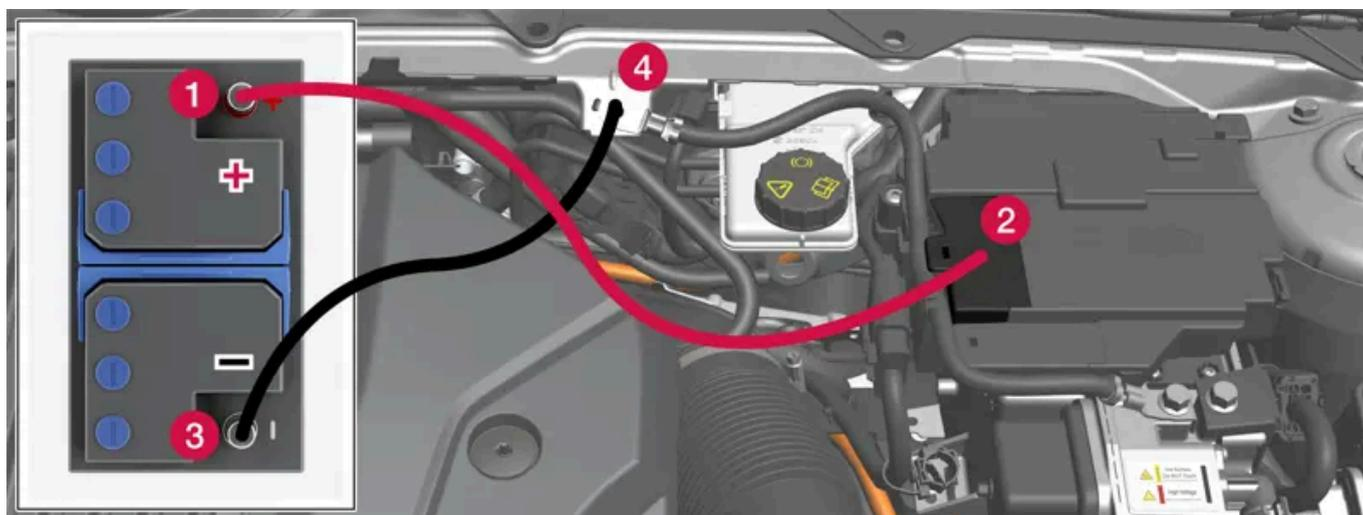
Points de charge pour le démarrage auxiliaire de la voiture. Le couvercle cache deux points de connexion. N'utilisez que celui qui se trouve le plus près de l'habitacle.
