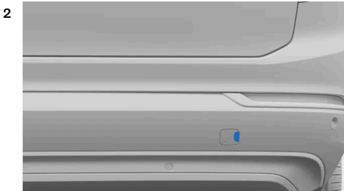
Cache de fixation d'anneau de remorquage arrière
