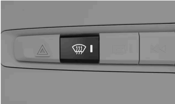
Κουμπί μέγιστου ξεπαγώματος στο πλαίσιο κουμπιών κάτω από την κεντρική οθόνη
