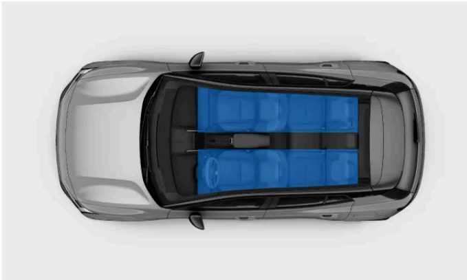
Διαθέσιμες ζώνες κλιματισμού.
