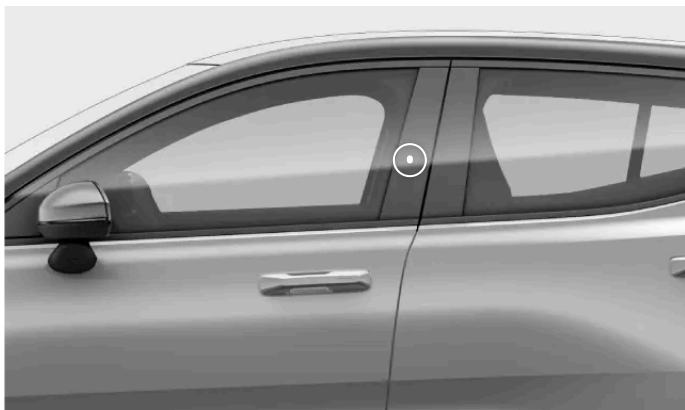
Θέση ανάγνωσης κλειδιού στην κολόνα της πόρτας
