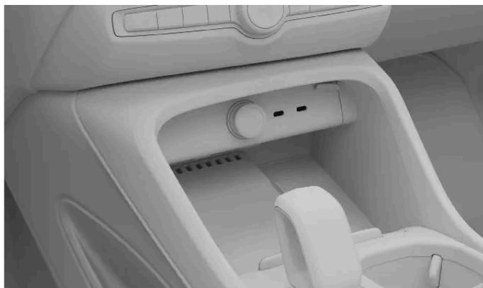
Ci sono anche due porte USB nella parte posteriore del tunnel centrale.
