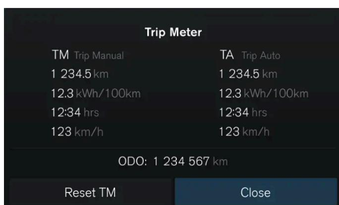
La tua auto è provvista di un contachilometri parziale e di un contachilometri. Il contachilometri parziale può mostrarti informazioni sulla distanza percorsa e sul tempo di guida della tua auto, oltre al consumo medio e alla velocità di guida.
