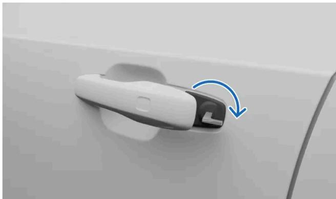
**5** Ruota la chiave di 45 gradi in senso antiorario fino alla posizione iniziale e rimuovila.
