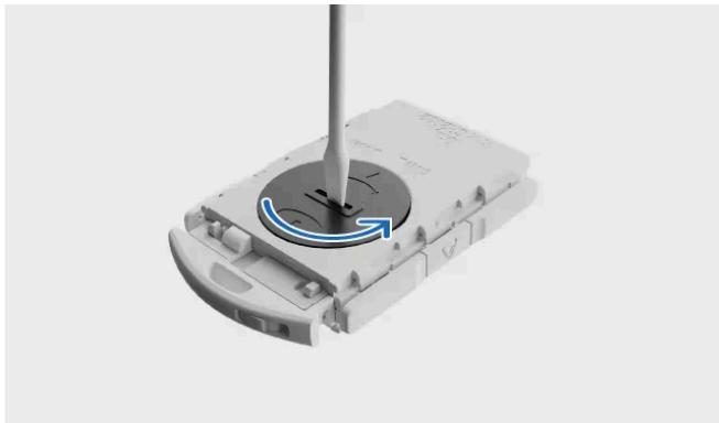
Utilizzando uno strumento adatto, come un cacciavite o una moneta, ruota il coperchio della batteria in senso antiorario per sbloccarlo.
