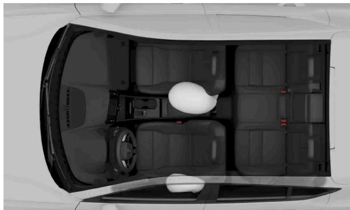
Airbag per collisioni laterali per i passeggeri anteriori In caso di impatto sul lato destro, si attivano sul lato opposto di ciascun sedile anteriore, in modo speculare rispetto allo scenario raffigurato.
