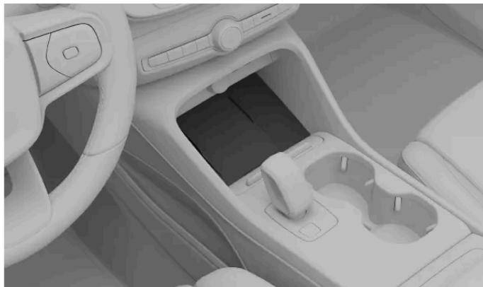
Per utilizzare il caricabatteria wireless, il tuo dispositivo deve essere certificato secondo lo standard di ricarica wireless Qi. Assicurati inoltre che la ricarica wireless sia abilitata sul dispositivo <sup>[1]</sup> e sul caricabatteria stesso. Puoi attivare il caricatore nel display centrale.
