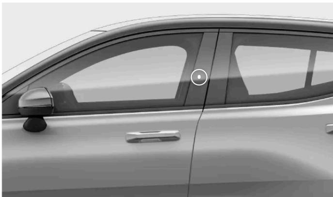
Punto di rilevamento delle chiavi sul montante della portiera del conducente.
