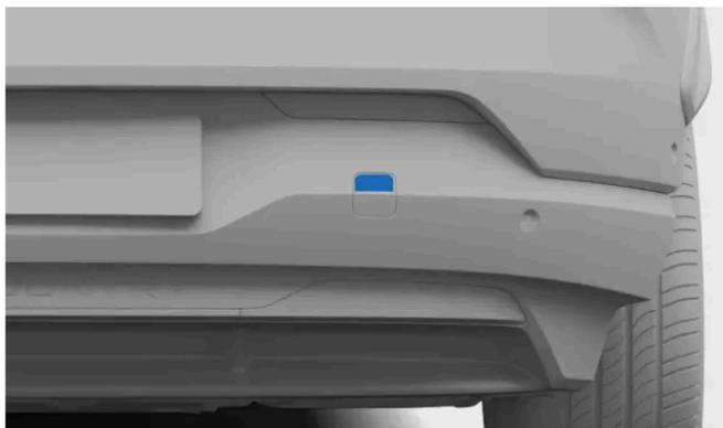
Coperchio di fissaggio dell'occhiello di traino posteriore.
