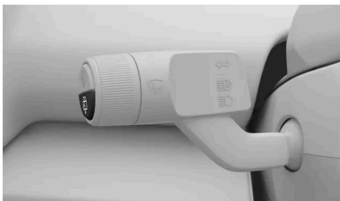
Puoi controllare il tergicristallo del lunotto posteriore utilizzando il pulsante inferiore sulla leva a volante lato sinistro.
