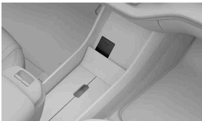
La posizione del lettore di chiavi elettroniche, che serve se si avvia l'auto con una chiave elettronica o una chiave con comando a distanza scarica.
