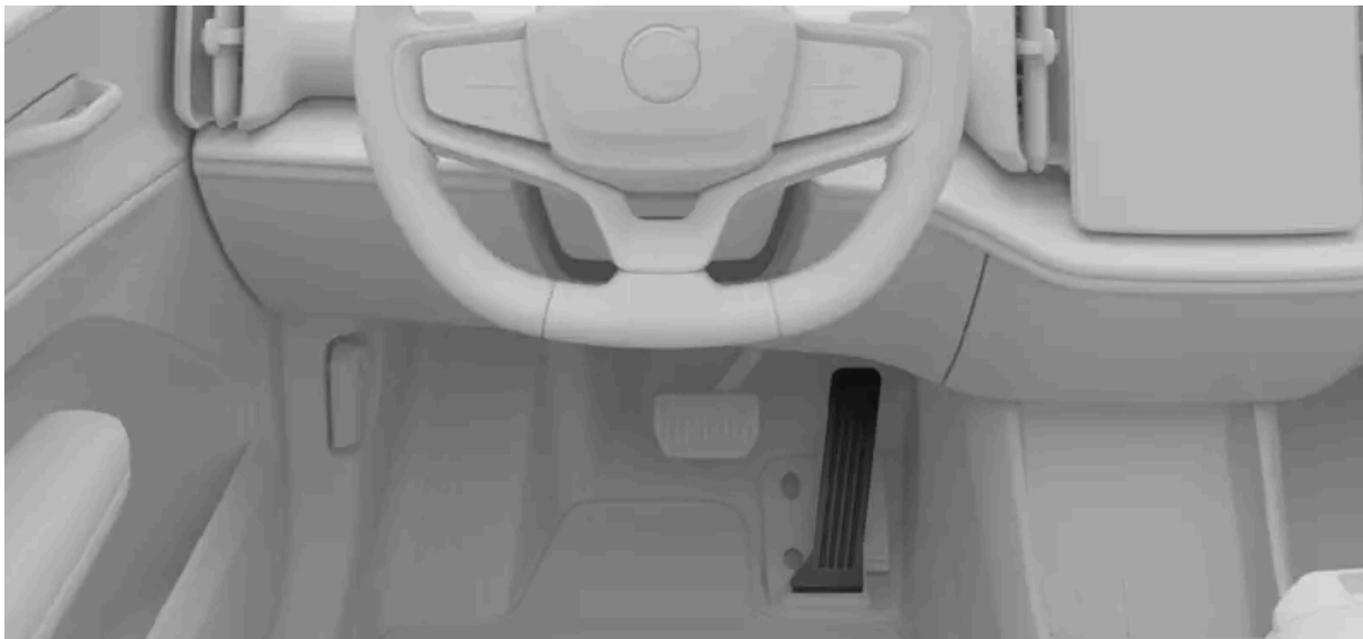
Il comportamento di frenata cambia quando usi il pedale acceleratore. Quando premi l'acceleratore, l'auto accelera normalmente ma se rilasci il pedale si attiva la frenata. Più premi il pedale, più aumenti l'azione frenante.
