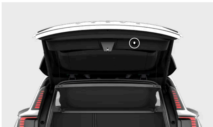
Posizione del pulsante di chiusura del bagagliaio.
