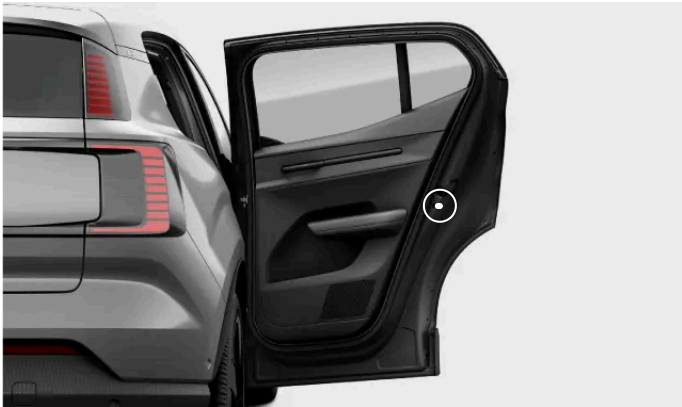
Posizione dell'interruttore della sicura per bambini.
