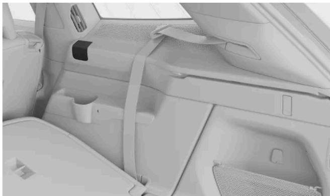
Rimuovi le protezioni delle rientranze sui lati del bagagliaio posteriore.
