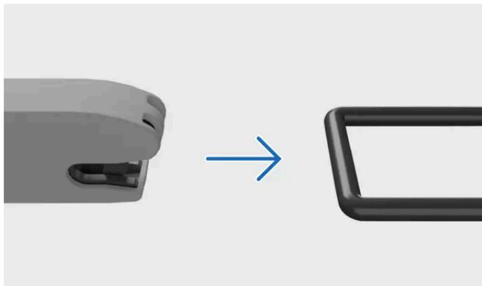
Fissare l'attacco ISOFIX nel punto di fissaggio
