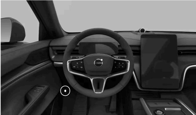
La prima leva si trova sotto il cruscotto sul lato del conducente, proprio davanti alla cerniera della portiera.
