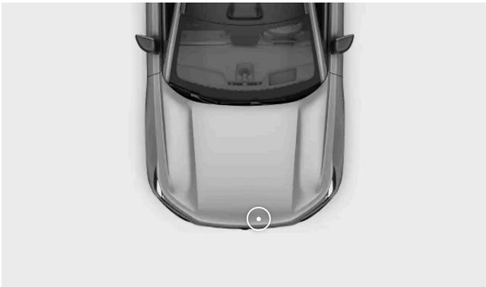
La seconda leva si trova sotto il bordo anteriore del cofano sul lato del conducente.
