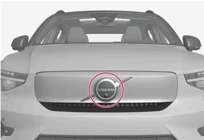
Posizione dell'unità radar anteriore
