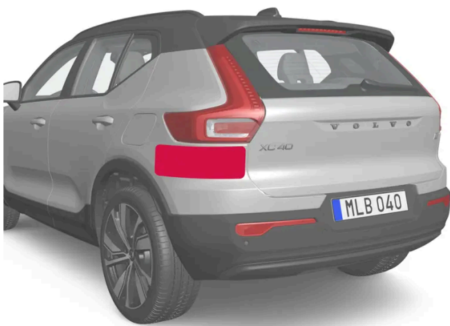
Posizione delle unità radar posteriori
