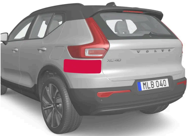
Posizione delle unità radar posteriori
