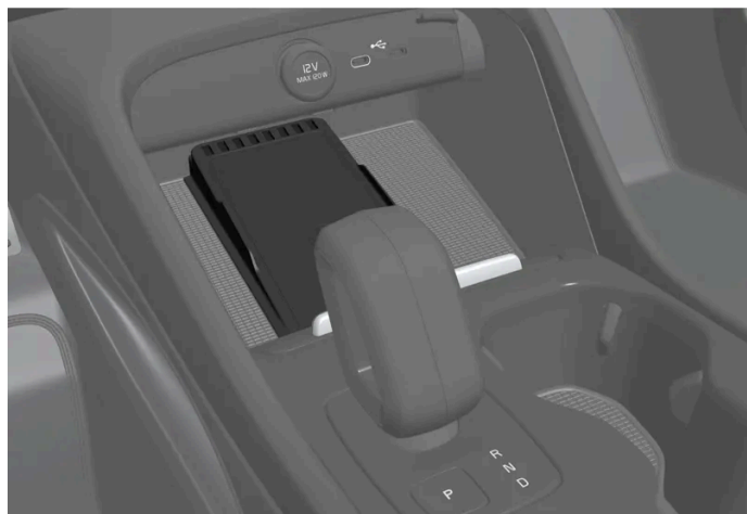
Caricabatteria wireless per telefono wireless davanti alla leva selettoria
