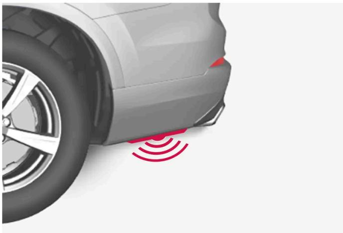
Per attivare l'apertura o la chiusura con il movimento del piede nelle automobili con skid plate, compiere il movimento di avvicinamento del piede dal lato dell'automobile. L'apertura e la chiusura sono consentite se una delle chiavi telecomando dell'automobile si trova nel campo di portata (circa 1 m - 3 piedi).
