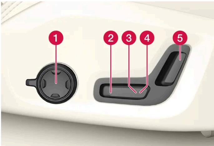
La figura illustra i comandi in un'automobile con supporto lombare a 4 vie\*. Le automobili con supporto lombare a 2 vie\* sono provviste di comando multifunzione girevole.
