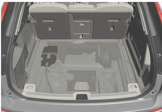
Le auto del tipo Mild Hybrid sono dotate invece di una batteria ausiliaria 48 V ubicata a sinistra nel vano di carico. La scatola sopra la batteria ausiliaria da 48 V può essere manipolata solo da riparatori autorizzati.
