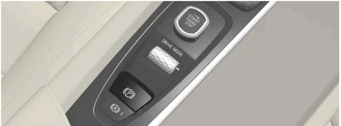
Il comando del freno di stazionamento si trova nel tunnel fra i sedili.
