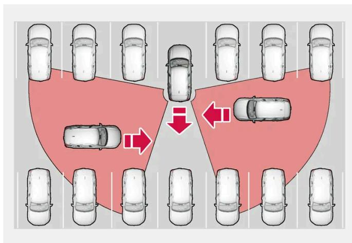
Esempi di aree in cui la funzione Cross Traffic Alert può aiutare il conducente a rilevare gli ostacoli in retromarcia.
