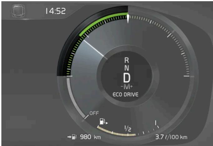
Misuratore ECO sul display del conducente da 12"\*. .
