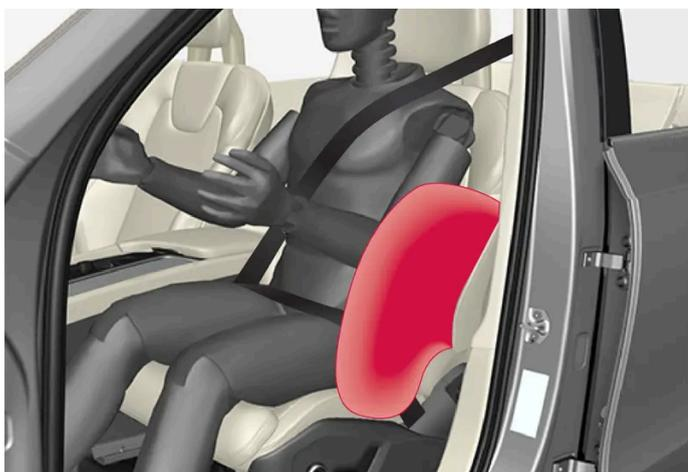
Gli airbag laterali sono montati sui lati esterni degli schienali dei sedili anteriori ed assistono a proteggere il conducente ed il passeggero del sedile anteriore.
