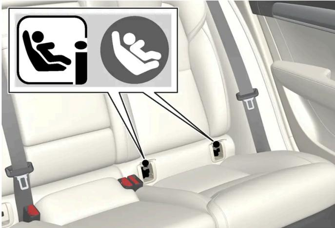
La posizione dei punti di fissaggio per il sedile posteriore è indicata da simboli<sup>[1]</sup> sul rivestimento dello schienale.
