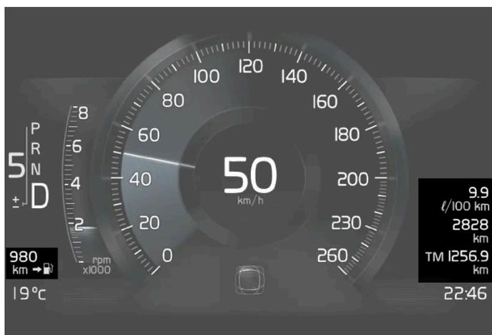
Esempio di informazioni del computer di bordo sul display del conducente da 8 pollici. La figura è schematica - i dettagli possono differire a seconda del modello di automobile.
