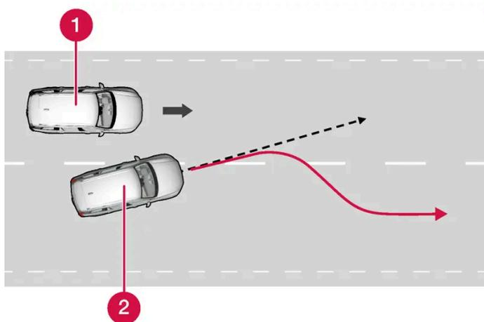
La funzione può assistere il conducente sterzando l'automobile per riportarla nella corsia di marcia.
