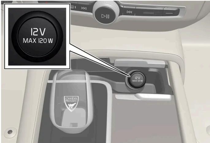
Presenza elettrica anteriore nel tunnel per le automobili con caricabatterie senza fili per telefono\*.
