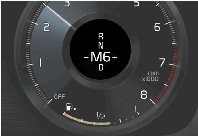
Indicatore cambio di marcia sul display del conducente da 12" per la leva selettore piccola\*.
