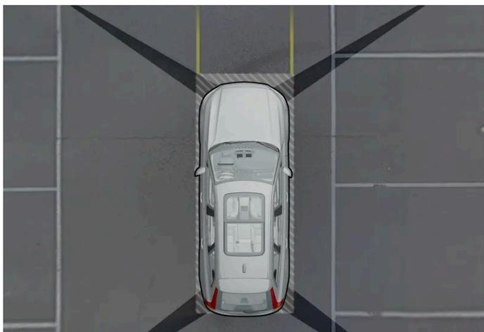
Esempio di "campo visivo" delle telecamere di parcheggio con area di copertura approssimativa.
