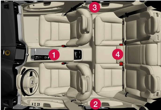
Posizione delle antenne:
