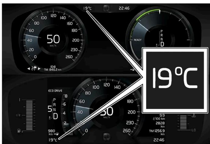
Posizione del termometro della temperatura esterna sui display del conducente da 12" e 8". La figura è schematica - i dettagli possono differire a seconda del modello di automobile.
