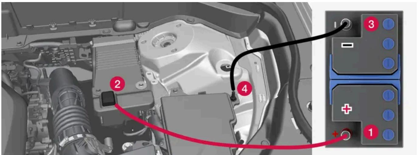
Punti di fissaggio dei cavi di avviamento. L'aspetto del vano motore può variare a seconda di modello di automobile e livello di equipaggiamento.
