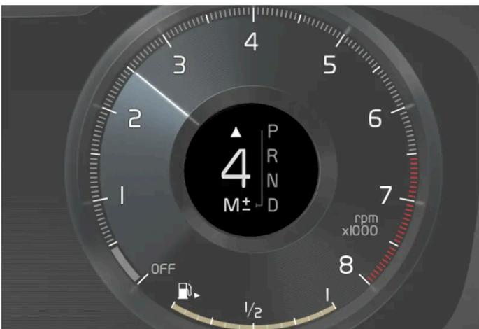
Indicatore cambio di marcia sul display del conducente da 12" per la leva selettoria grande\*.
