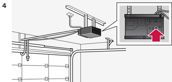
Localizzare il pulsante di apprendimento<sup>[2]</sup> del ricevitore, ad esempio del portone del garage. Solitamente si trova accanto all'attacco dell'antenna sul ricevitore.
