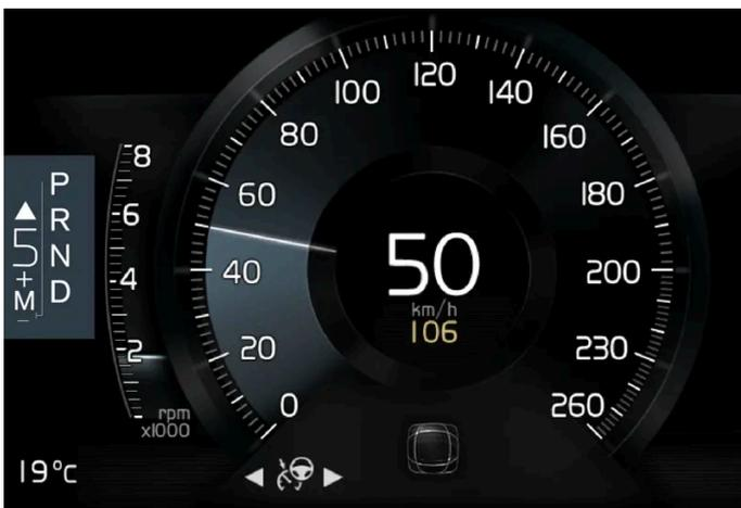
Indicatore cambio di marcia sul display del conducente da 8" per la leva selettore grande.
