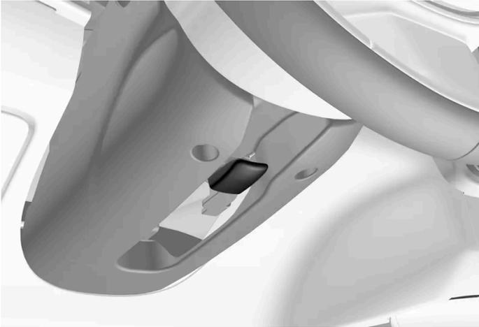
Leva per la regolazione del volante.
