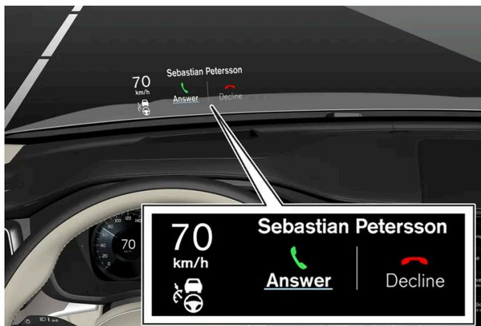
L'Head-Up Display visualizza avvertimenti e informazioni su velocità, funzioni del regolatore elettronico della velocità, navigazione ecc. nel campo visivo del conducente. Sull'Head-Up Display possono essere visualizzate anche indicazioni su segnali stradali e chiamate in arrivo.
