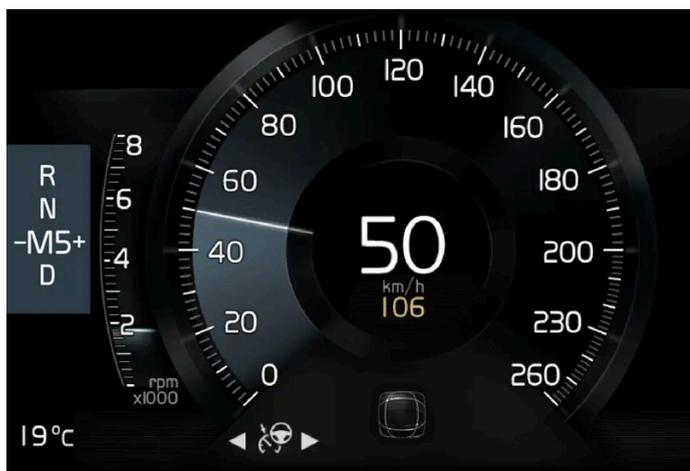
Indicatore cambio di marcia sul display del conducente da 8" per la leva selettoria piccola.
