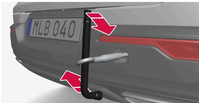
Serrare l'occhiello a fondo, ad esempio inserendovi la chiave per i dadi delle ruote\* per fare leva.
