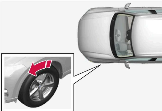
La freccia indica il senso di rotazione del pneumatico.
