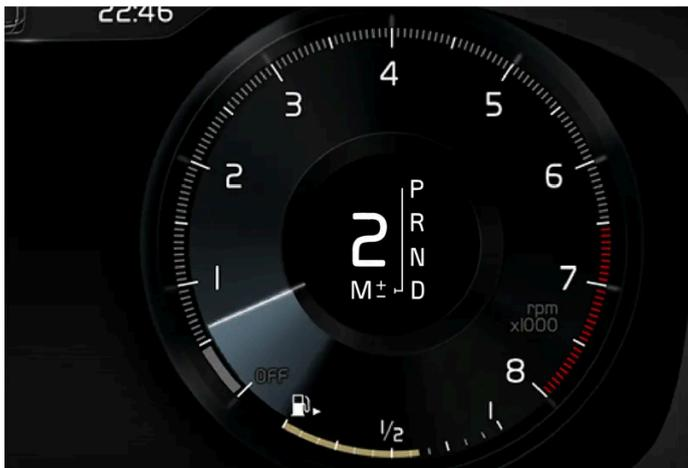
Panoramica dello schema di cambio sul display del conducente per la leva selettore grande.
