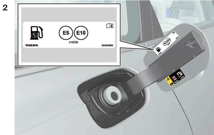
Utilizzare un carburante approvato per l'automobile, vedere l'identificatore<sup>[1]</sup> all'interno dello sportello del serbatoio. Per informazioni su carburanti approvati e identificatore, vedere la sezione "Benzina" o "Diesel".
