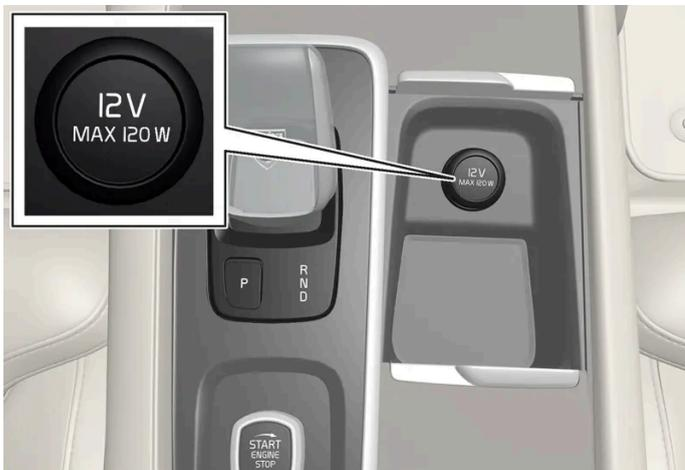
Presenza elettrica anteriore nel tunnel per le automobili senza caricabatterie senza fili per telefono\*.
