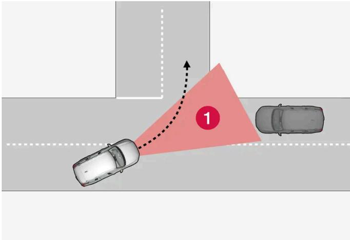
**1** Settore in cui City Safety è in grado di rilevare un veicolo che procede in direzione trasversale opposta.
