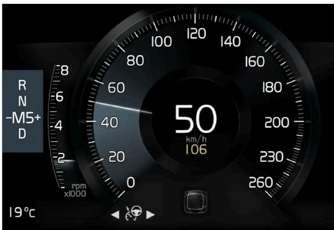
Indicatore cambio di marcia sul display del conducente da 8" per la leva selettore piccola.
