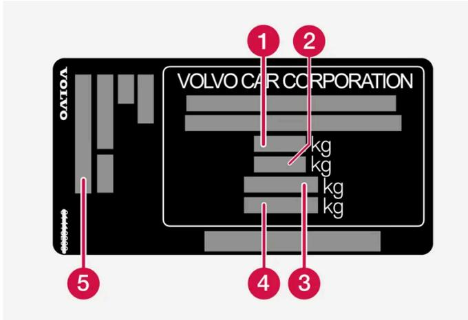
L'etichetta si trova sul montante della portiera ed è visibile aprendo la portiera posteriore destra.
