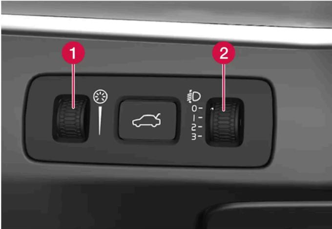
Le automobili con fari a LED<sup>[3]</sup> \* sono dotate di comando incidenza fari automatico, quindi sono sprovviste della rotella per la regolazione dell'incidenza fari.
