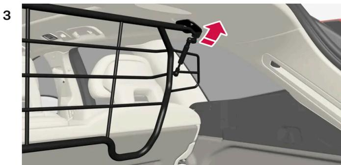
Sistemare i dispositivi di fissaggio della griglia protettiva negli attacchi del padiglione.
