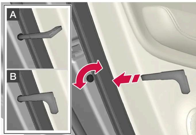
Sicura per bambini manuale. Da non confondere con il bloccaggio manuale della portiera.
