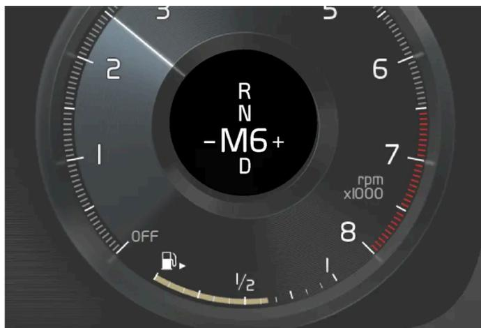
Indicatore cambio di marcia sul display del conducente da 12" per la leva selettoria piccola\*.
