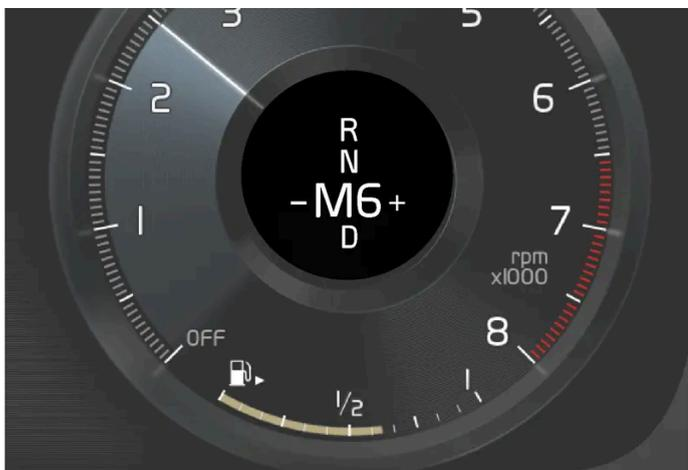
Panoramica dello schema di cambio sul display del conducente per la leva selettore piccola.
