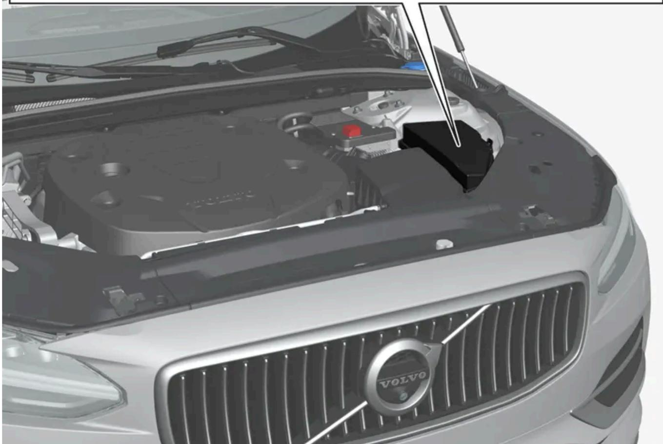
All'interno della copertura è collocata una pinza che semplifica la rimozione e l'installazione dei fusibili.
