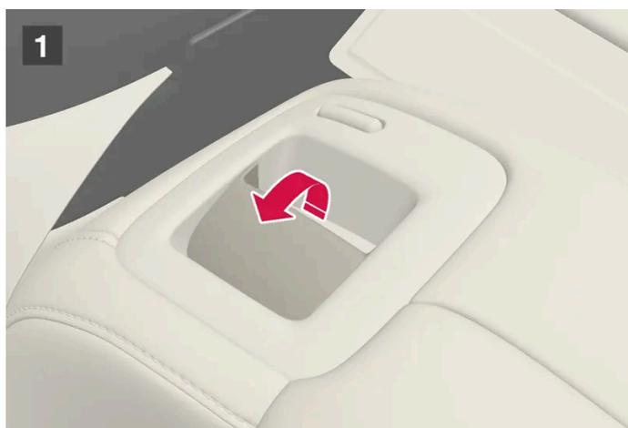
Nelle automobili con ripiegamento elettronico\* dei poggiatesta è possibile ripiegare i poggiatesta esterni con le maniglie sul lato superiore del sedile, vedere l'illustrazione **1**. Notare che con questo metodo vengono ripiegati anche gli schienali. Se devono essere ripiegati solo i poggiatesta, per esempio per migliorare la visibilità, procedere invece mediante il display centrale\*.
