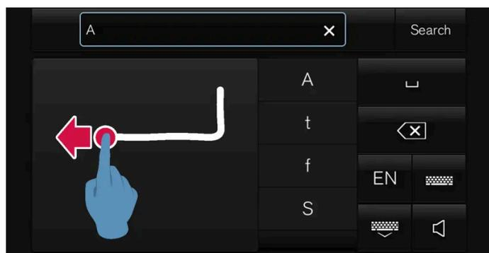
Per cambiare riga manualmente, disegnare il carattere sopra nel campo di scrittura manuale<sup>[3]</sup>.
