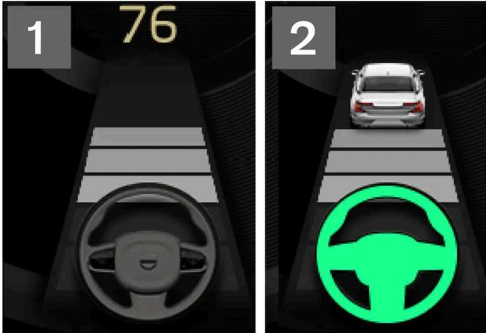
2 Quando il simbolo del volante sul display del conducente è acceso, il Pilot Assist contribuisce alla sterzata.
