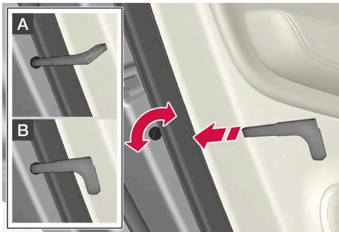
Sicura per bambini manuale. Da non confondere con il bloccaggio manuale della portiera.
