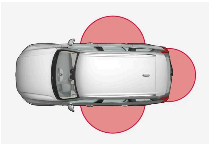
L'area marcata in figura mostra le aree coperte dalle antenne del sistema.
