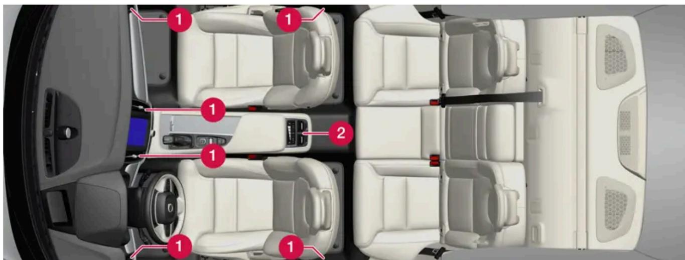
Posizione delle bocchette di ventilazione regolabili nell'abitacolo.
