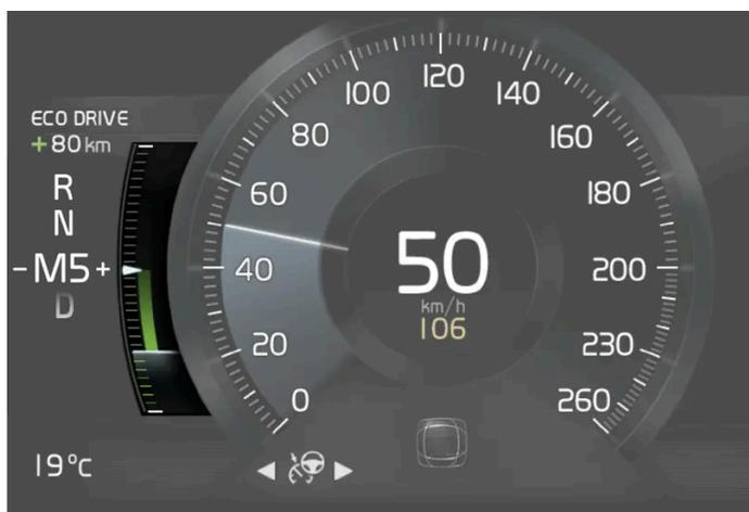
Misure ECO sul display del conducente da 8".
