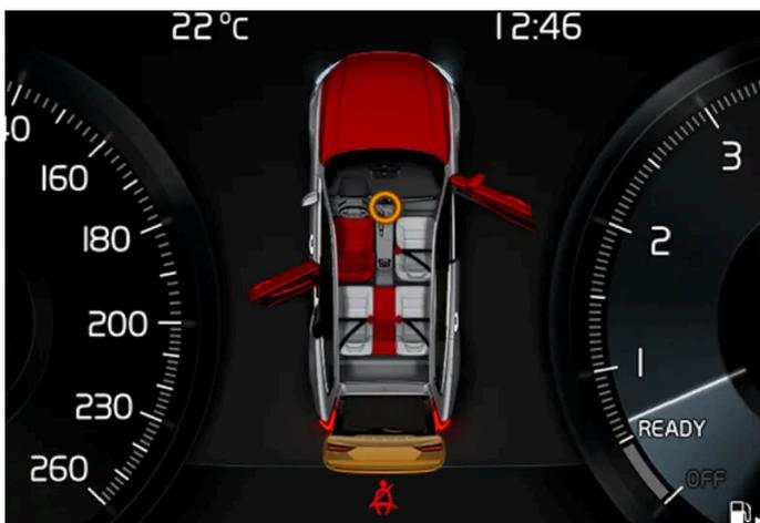
Grafica nel display del conducente con vari tipi di avvertimento. Il colore di segnalazione sulla portiera ed il portellone varia a seconda della velocità dell'auto.
