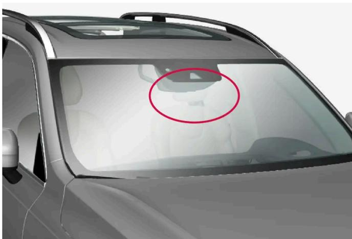
Posizione dell'unità telecamera e radar anteriore
