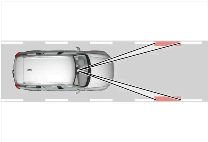
Driver Alert Control rileva la posizione dell'automobile nella corsia di marcia.
