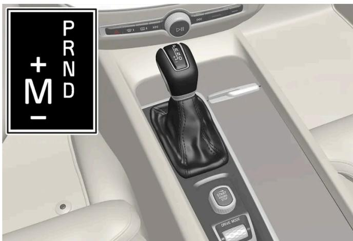
Panoramica della leva selettoria grande e schema di cambio sul display del conducente.
