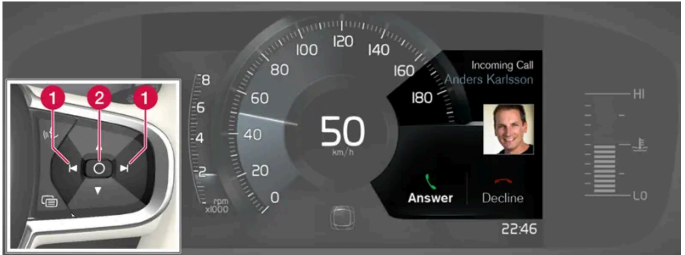
운전자 화면에 표시되는 메시지 [1]의 예 및 스티어링휠의 우측 키패드 그림은 참고용이며 차량 모델에 따라 부분이 다를 수 있습니다.
