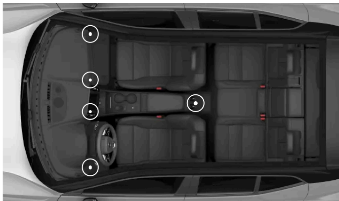
Position des buses de ventilation réglables
