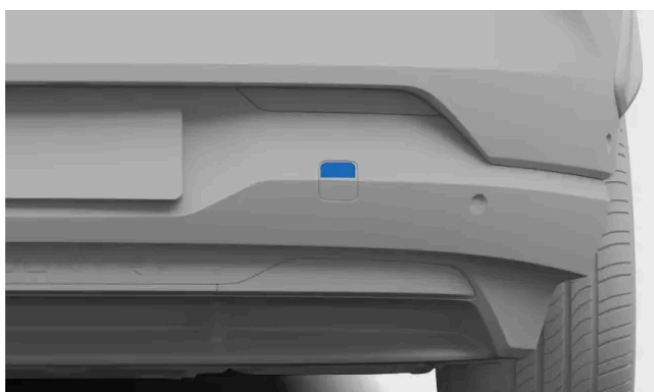
Cache de fixation d'anneau de remorquage arrière
