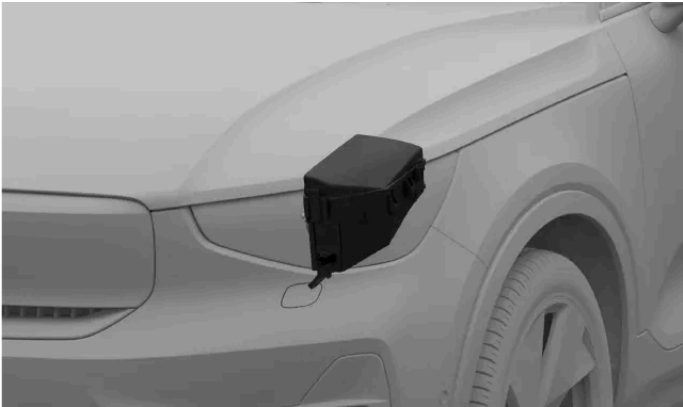
Emplacement de la boîte à fusibles
