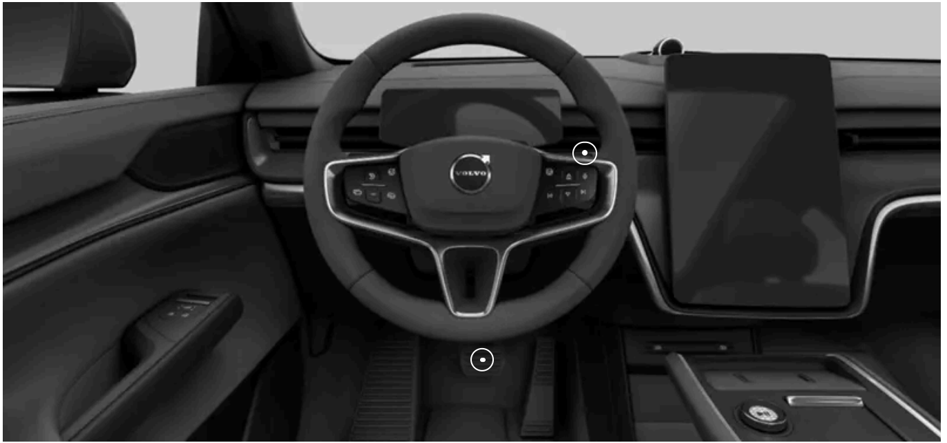
Principaux points d'interaction pour le démarrage de votre voiture, à savoir la pédale de frein et le levier de rapport
