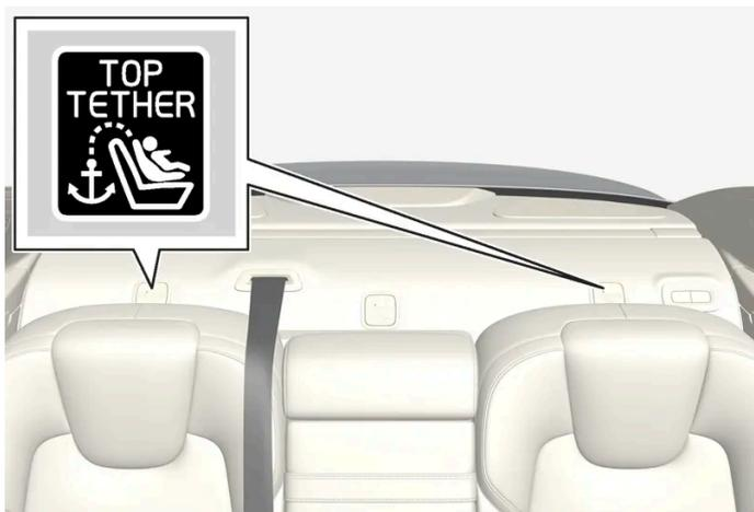
L'emplacement des points de fixation pour la banquette arrière est indiqué par des symboles sur la plage arrière, derrière la banquette arrière.
