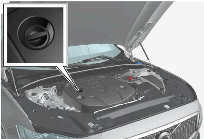
Tuyau de remplissage<sup>[1]</sup>,<sup>[2]</sup>
