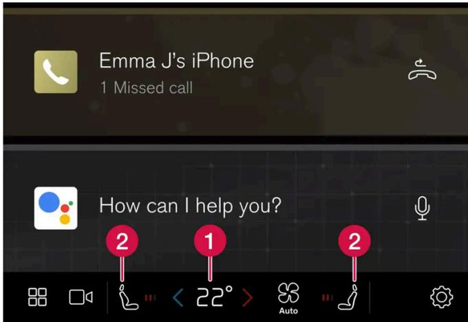
1 Commande de température pour les côtés conducteur et passager.<sup>[1]</sup>
