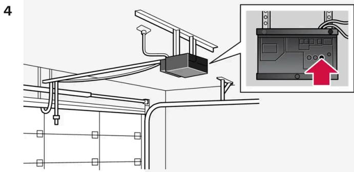
Cherchez le bouton d'apprentissage<sup>[2]</sup> sur le récepteur de la porte de garage par exemple. Il est généralement placé près de la fixation de l'antenne sur le récepteur.
