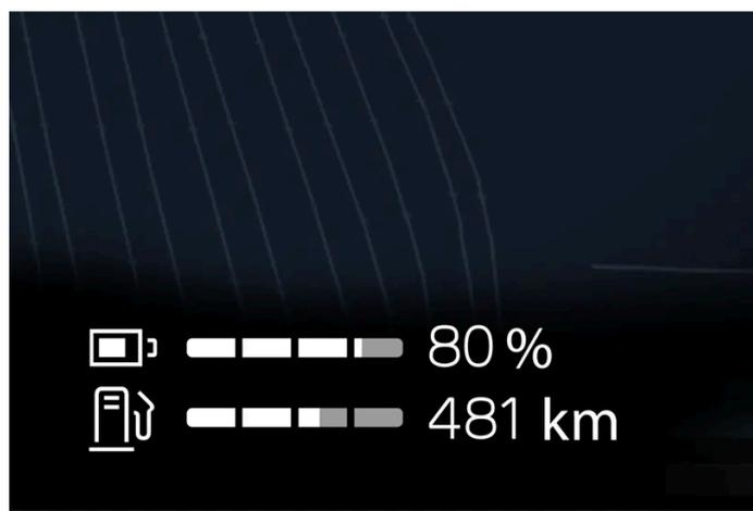
La jauge de la batterie située dans la partie inférieure de l'écran conducteur indique le degré de recharge de la batterie ainsi que l'autonomie restante.
