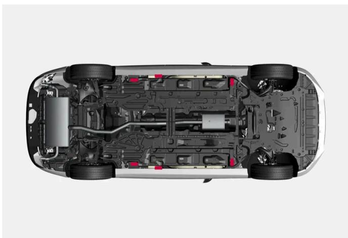
La voiture dispose de points de levage extérieurs, pour un levage limité, et de points de levage intérieurs pour un levage d'une plus grande ampleur, à l'aide d'un cric d'atelier ou de bras de levage, par exemple.
