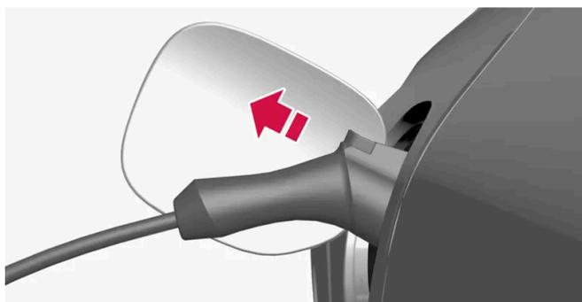
Débranchez le câble de charge de la prise de charge de la voiture et fermez la trappe.
