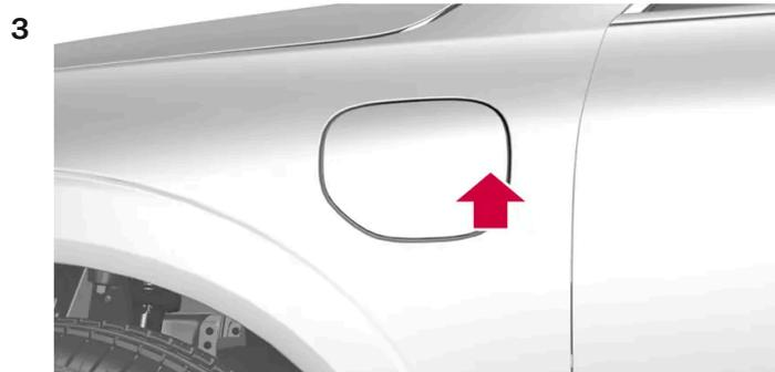
Appuyez sur la partie arrière de la trappe de recharge pour l'ouvrir<sup>[2]</sup>.
