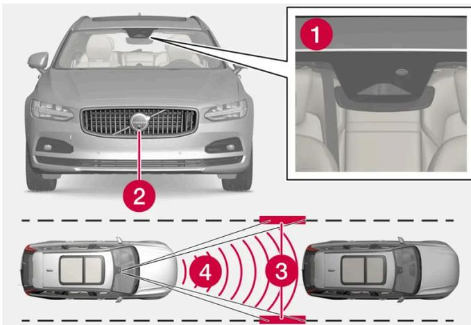
Les unités de caméra/radar mesurent la distance au véhicule qui précède et détectent les marquages au sol.
