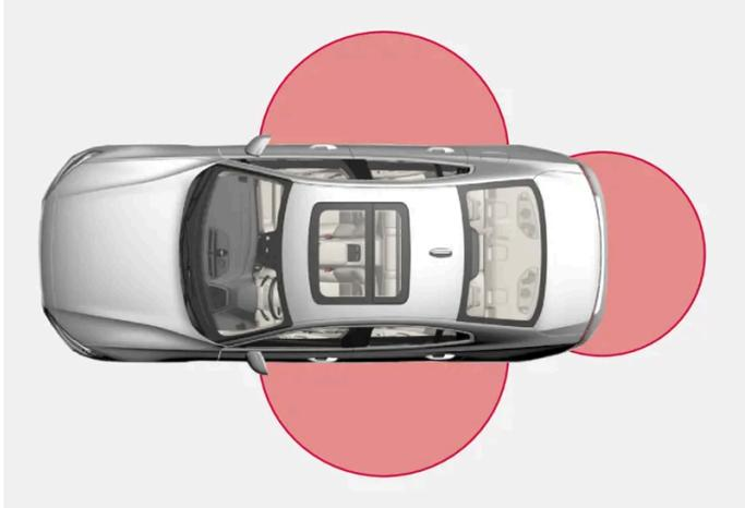
Pour les fonctions sans clé, une clé doit se trouver à une distance de 1 à 1,5 mètre (3 à 5 pieds) environ des portes ou du coffre à bagages de la voiture.
