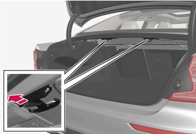
Déployez le crochet depuis la face inférieure de la plage arrière. Suspendez les sacs équipés d'une poignée à hauteur adéquate sur les crochets.
