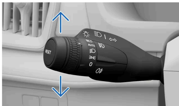
Clignotants sur le levier au volant gauche
