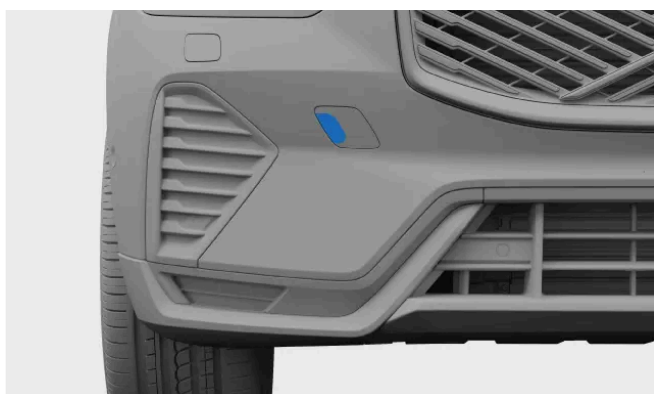
Cache de fixation d'anneau de remorquage avant
