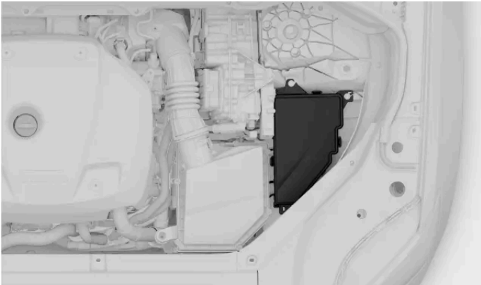
Emplacement de la boîte à fusibles
