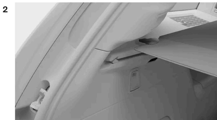
Soulevez les extrémités de la protection du cache-bagages dans le coude. Tenez la poignée et guidez la protection du cache-bagages hors des rainures supérieures. Cela permet à la protection de se rétracter automatiquement.
