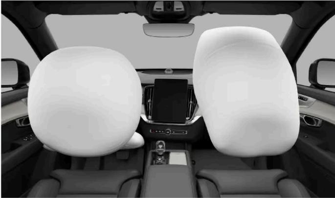
Le côté conducteur est équipé de deux coussins gonflables avant. Le coussin gonflable supérieur est placé à l'intérieur du volant, et le coussin gonflable de genou est placé derrière un panneau en dessous du volant.
