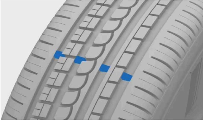
Les talons étroits placés en travers des sculptures du pneumatique sont des témoins d'usure. Sur le côté du pneumatique figure la mention TWI <sup>[1]</sup>.
