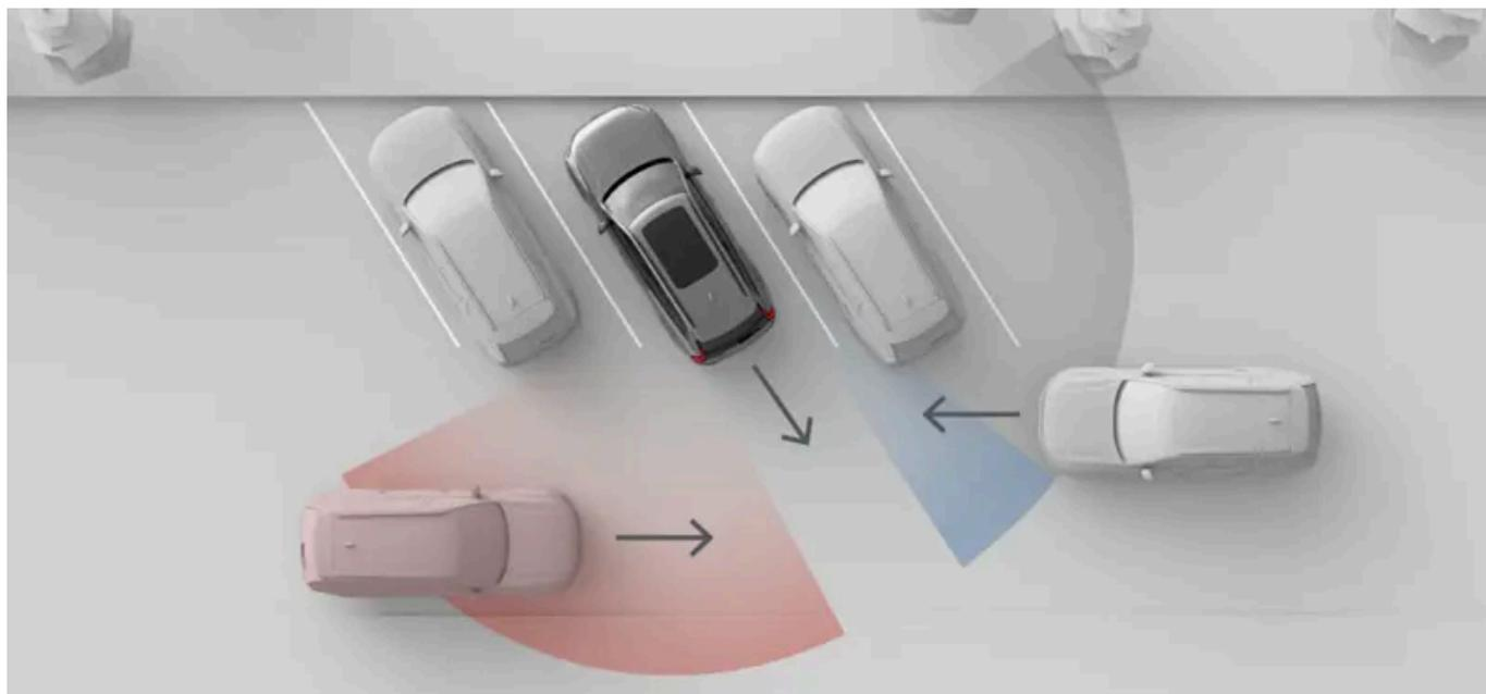
Cette image illustre la façon dont des objets environnants, par exemple des voitures en stationnement, peuvent limiter la capacité de la voiture à détecter d'autres véhicules et des situations à risque. En l'absence d'obstacle, les zones de détection effective sont identiques des deux côtés.
