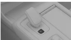
Lorsque P est sélectionné, la boîte de vitesses est bloquée mécaniquement pour éviter les changements de rapports accidentels.
