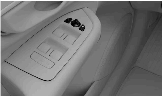
Commandes de réglage des rétroviseurs extérieurs
