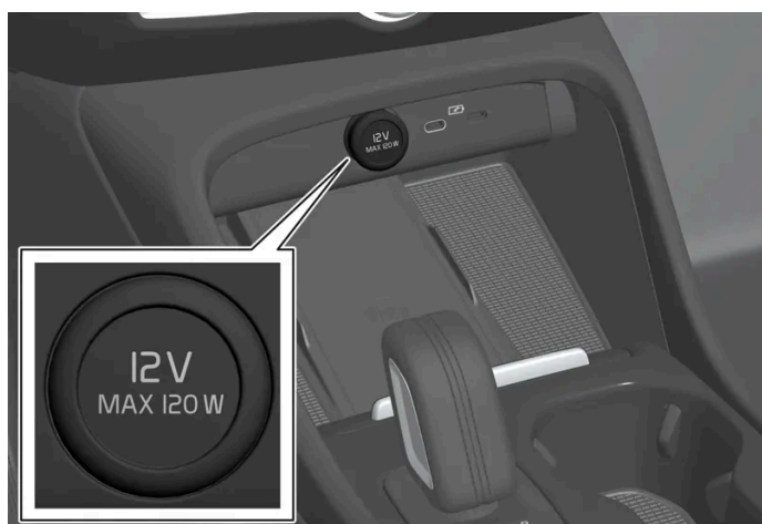
12V-aansluiting in tunnelconsole, voorin.
