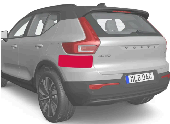
Locatie van de radarsensoren aan de achterzijde
