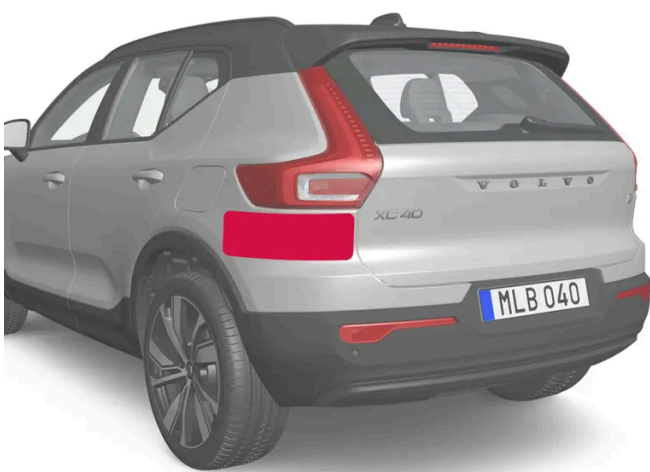
Locatie van de radarsensoren aan de achterzijde
