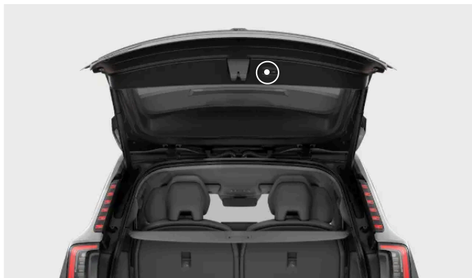
De locatie van de sluitknop voor de achterklep
