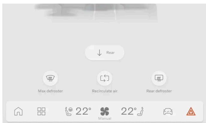
De knop voor de gevaarlichten bevindt zich op het middendisplay
