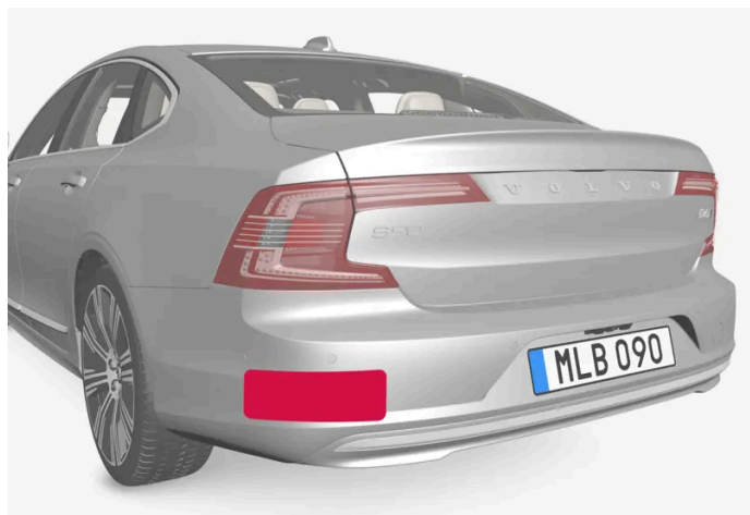
Locatie van de radarsensoren aan de achterzijde
