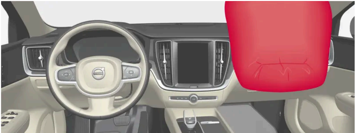
Airbag voor de voorstoel aan passagierszijde.
