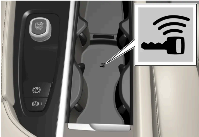
Positie back-uplezer in de tunnelconsole.
