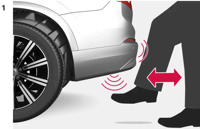
Schopbeweging binnen het activeringsbereik van de sensor.
