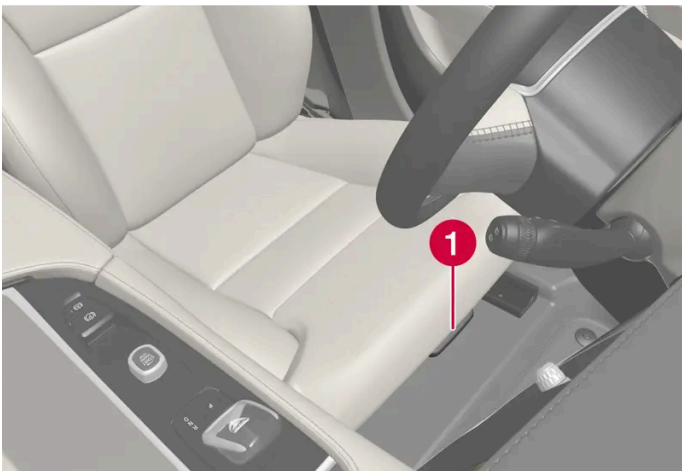
Handgreep voor verstelling van het zitkussen.
