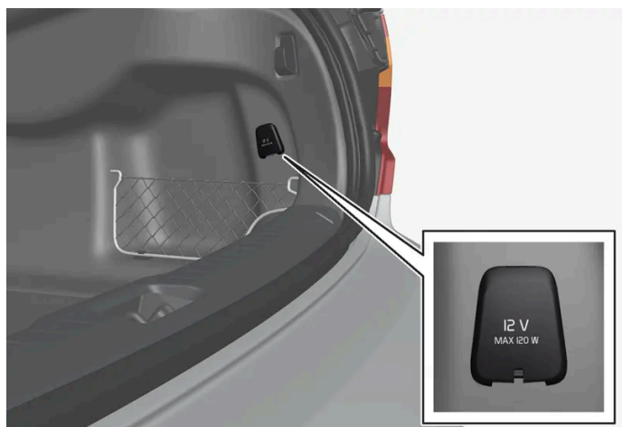
12V-aansluiting in kofferbak/bagageruimte*.
