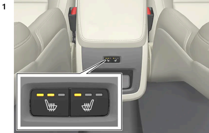
Knoppen voor elektrische achterbankverwarming achter op tunnelconsole.
