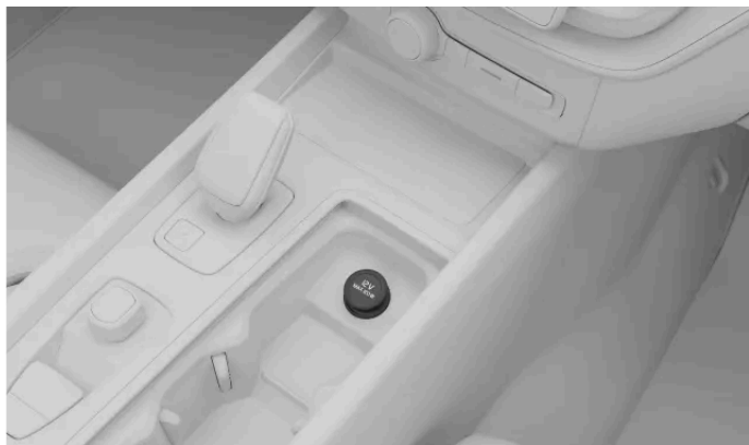
De 12V-aansluiting in de tunnelconsole
