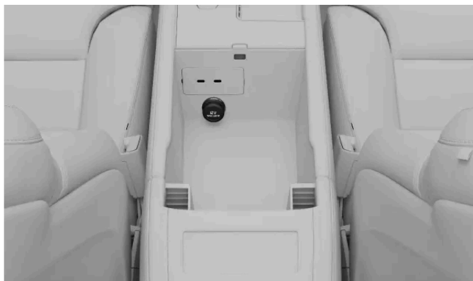
De 12V-aansluiting in de tunnelconsole
