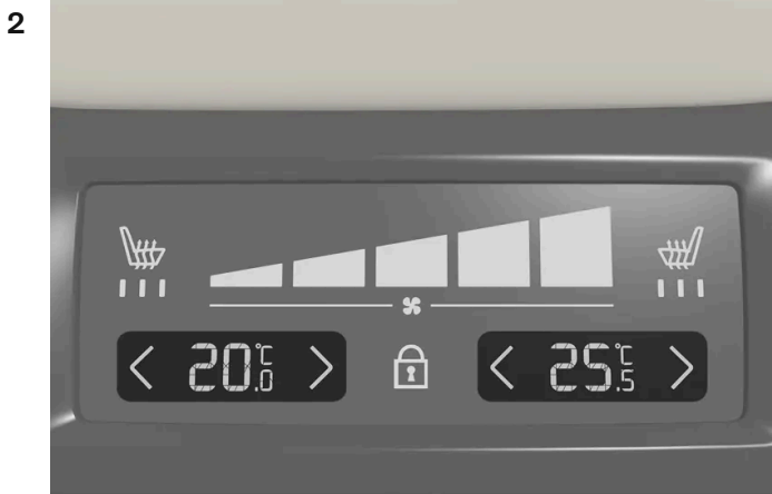
Temperatuurregeling op klimaatpaneel achter op tunnelconsole.
