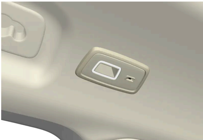
In een auto met panoramadak* zitten de twee lampeenheden aan beide kanten van het plafond. [2]
