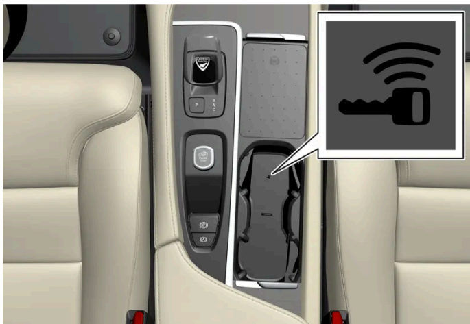
Positie back-uplezer in de tunnelconsole.
