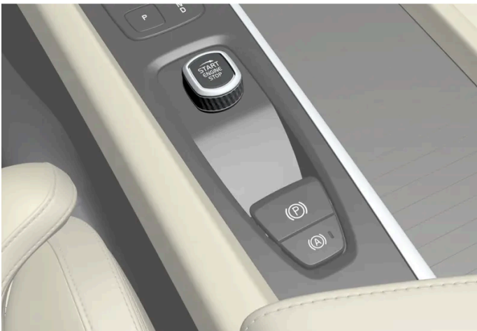
De startknop op de tunnelconsole.
