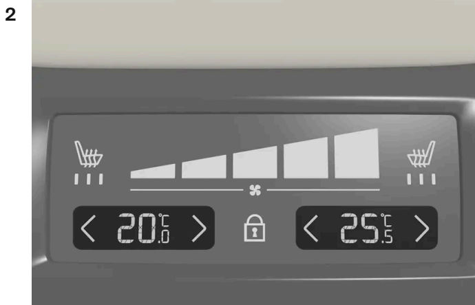
Temperatuurregeling op klimaatpaneel achter op tunnelconsole.
