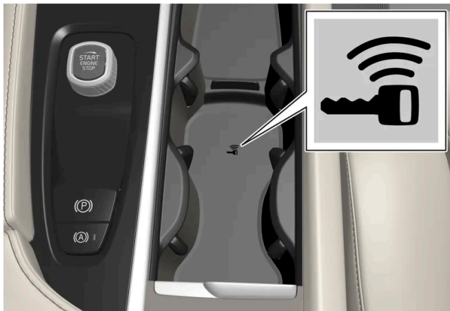
Positie back-uplezer in de tunnelconsole.
