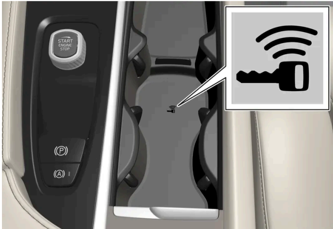
Positie back-uplezer in de tunnelconsole.
