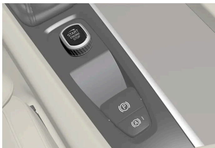
De startknop op de tunnelconsole.
