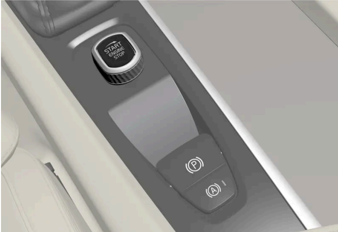
De startknop op de tunnelconsole.
