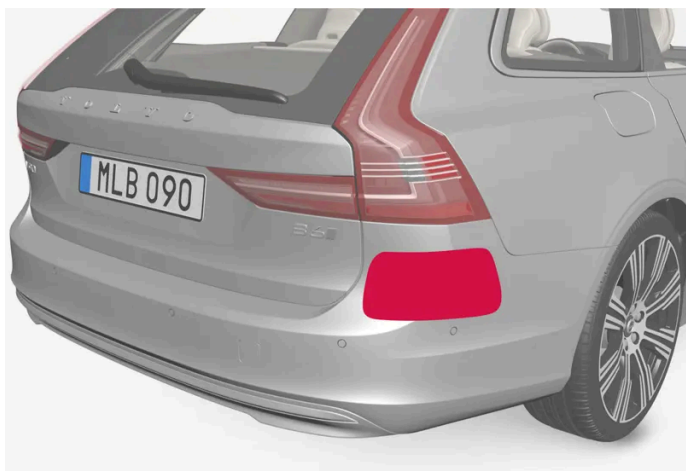
Locatie van de radarsensoren aan de achterzijde
