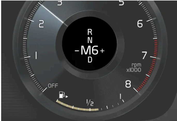
Schakelindicator op 12 inch bestuurdersdisplay voor de kleine schakelhendel*.
