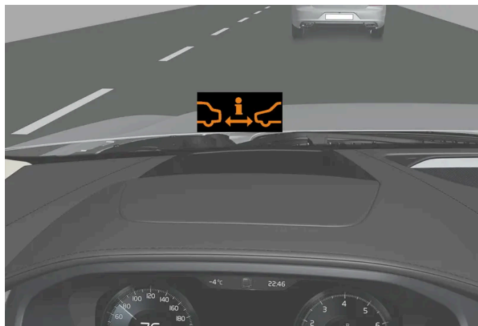
Symbool voor afstandswaarschuwing op een voorruit met head-updisplay.
