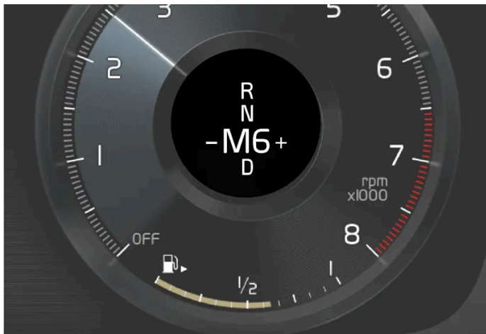
Overzicht handmatige schakelstand op bestuurdersdisplay.
