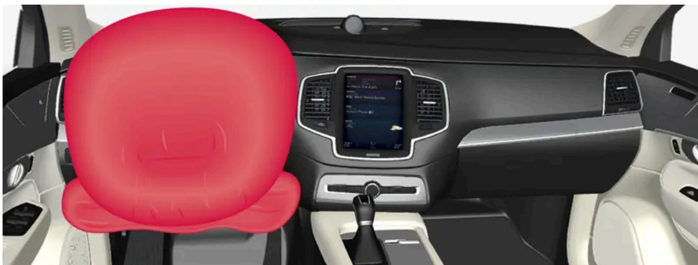
De stuurairbag en knie-airbag voorin aan de bestuurderszijde.
