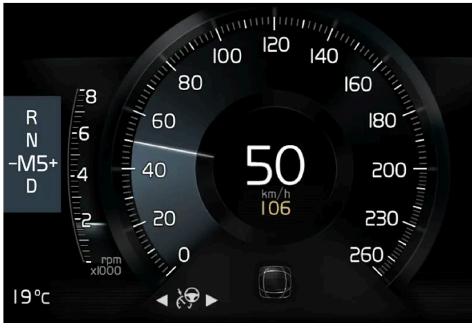
Schakelindicator op 8 inch bestuurdersdisplay voor de kleine schakelhendel.
