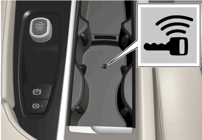
Positie back-uplezer in de tunnelconsole.
