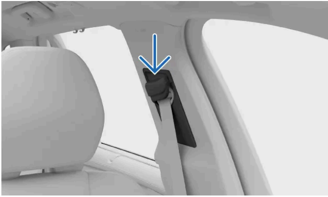
Bovenste bevestigingspunt van de stoel
