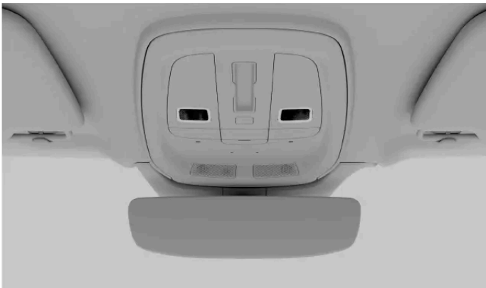
De leeslampjes voorin in de plafondconsole
